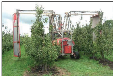
Rys. 11. Sadownicze opryskiwacze recyrkulacyjne
