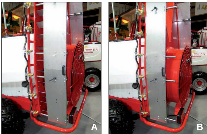
Rys. 24. Szczelina wylotowa deflektora: A – otwarta; B - zamknięta.
