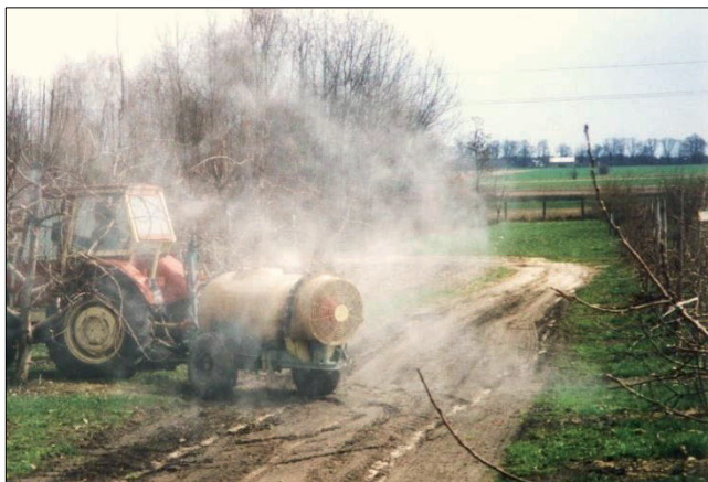
Rys. 25. Na uwrociach rozpylacze należy bezwzględnie wyłączyć
