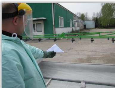
Rys. 73. Ocena kąta rozpylania z wykorzystaniem papierowego wzorca.
