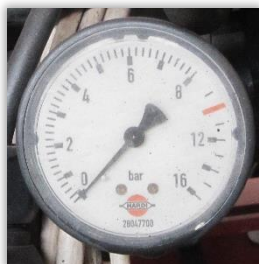
Rys. 50. Manometr z prawidłową działką elementarną - skala w barach.
