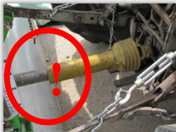
Rys. 2. Wałek z niekompletną osłoną
