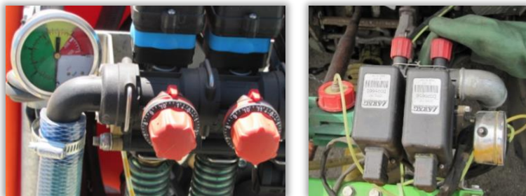
Rys. 114 i 115. Regulację zaworów kompensacyjnych opryskiwacza sadowniczego z oznaczeniem pozycji ustawienia zaworu.
