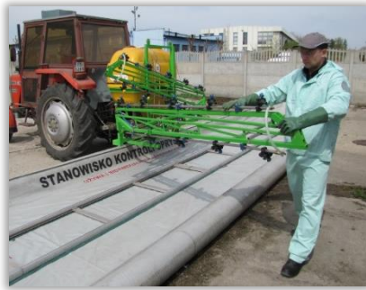
Rys. 63 i 64. Test ręcznego składania - rozkładania belki polowej.
