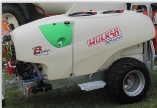
Rys. 94. Wycieki z pompy opryskiwacza należy oceniać po wyłączeniu napędu.
