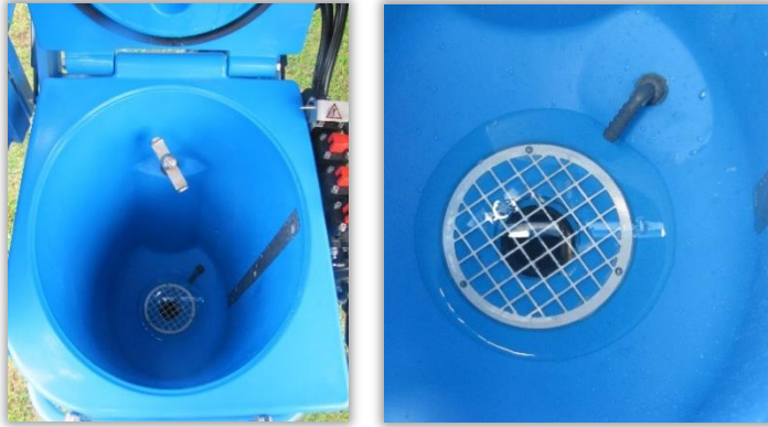
Rys. 43 i 44. Sito we wnętrzu rozwadniacza zatrzymujące przedmioty o wymiarach większych niż 20 mm.
