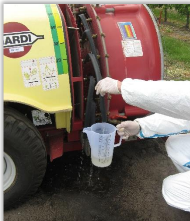
Rys. 127. Pomiar wydatku rozpylaczy z wykorzystaniem kubka miarowego i fragmentów dętek rowerowych.
