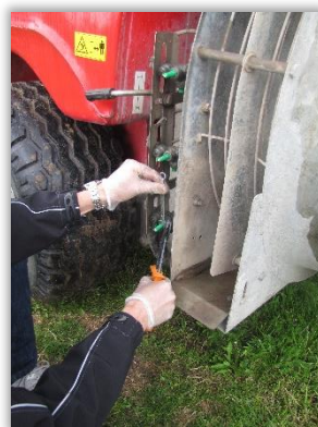
Rys. 121. Rozpylacze płaskostrumieniowe sadownicze nieprawidłowo ustawione - płaszczyzny strumieni cieczy przecinają się.
