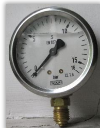
Rys. 52. Manometr ze zbyt małą dokładną podziałką (do 5 bar) - skala w barach.
