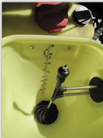
Rys. 46 i 47. Płuczka opakowań po środkach ochrony montowana w rozdawniczu bocznym opryskiwacza (46) i test płuczki (47).
