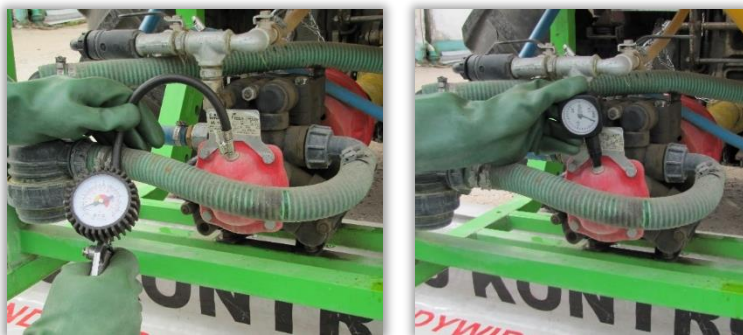
Rys. 18 i 19. Kontrola ciśnienia w powietrzniku za pomocą manometru na przewodzie ciśnieniowym pompy lub sprężarki (18) i prostym ciśnieniomierzem.
