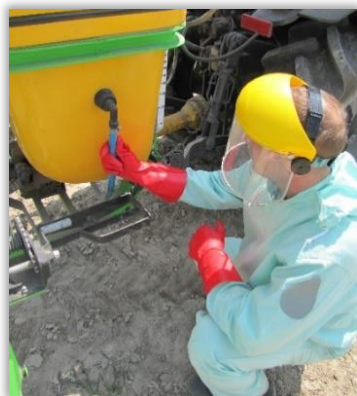
Rys. 11. Kontrola szczelności połączeń przewodów cieczowych ze zbiornikiem.
