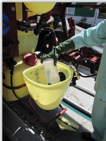
Rys. 46 i 47. Płuczka opakowań po środkach ochrony montowana w rozdawniczu bocznym opryskiwacza (46) i test płuczki (47).
