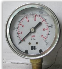
Rys. 51. Manometr ze zbyt małym zakresem pomiarowym (do 250 kPa / 2,5 bar) - skale w kPa i psi (funty na cal kwadratowy).
