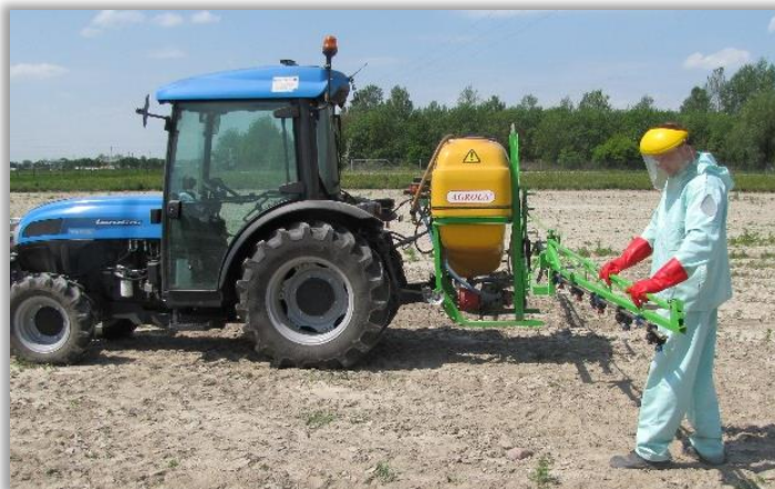
Rys. 62. Test stabilności belki polowej - wywoływanie ruchów pionowych i poziomych belki.
