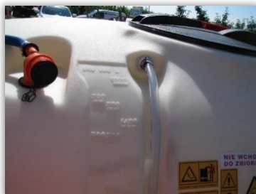
Rys. 97. Skala zbiornika opryskiwacza sadowniczego wyrażona w galonach i litrach z wskazaną pojemnością nominalną.
