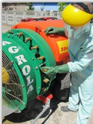
Rys. 119 i 120. Kontrola stanu zamocowania korpusów rozpylaczy do przewodów zasilających na ramie (119) i do indywidualnych przewodów (120).
