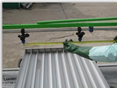
Rys. 70. Pomiar odległości między rozpylaczami zainstalowanymi na belce polowej opryskiwacza polowego za pomocą przymiaru wstęgowego.
