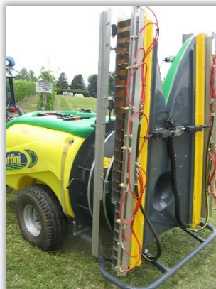
Rys. 119 i 120. Kontrola stanu zamocowania korpusów rozpylaczy do przewodów zasilających na ramie (119) i do indywidualnych przewodów (120).
