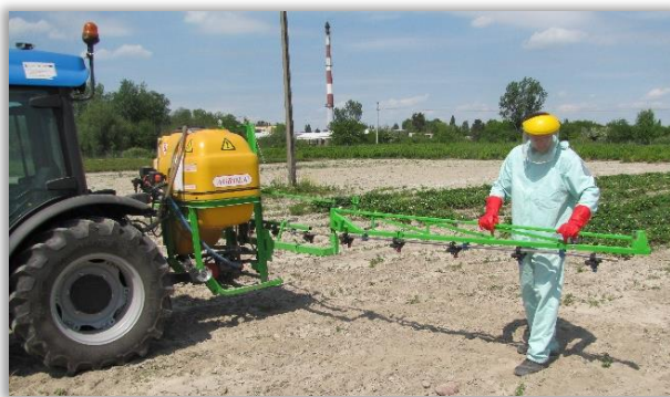
Rys. 71. Test układu amortyzacji i stabilizacji belki polowej.
