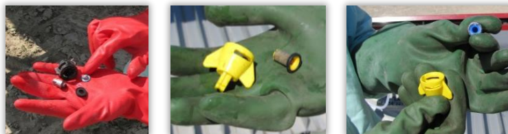
Rys. 75-77. Filtry rozpylaczy: typ 1 (75), typ 2, rozmiar 1 (76), typ 2, rozmiar 2.
