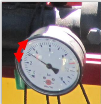
Rys. 53. Manometr z zaznaczonym zakresem drgań wskazówki.
