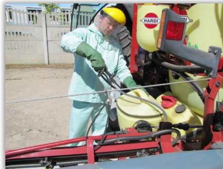
Rys. 45. Płukanie wnętrza rozwadniacza za pomocą specjalnej lancy.
