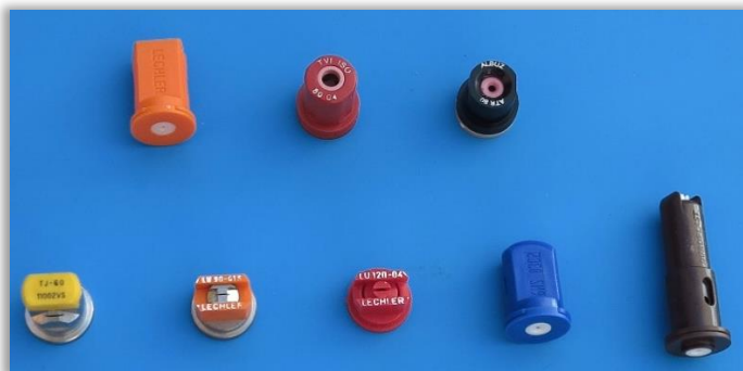
Rys. 74. Oznaczenie fabryczne rozpylaczy powinno zawierać typ i rozmiar rozpylacza.
