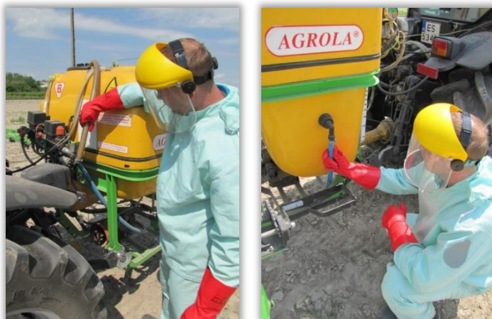
Rys. 57 i 58. Sprawdzanie jakości połączeń układu cieczowego w opryskiwaczu polowym.
