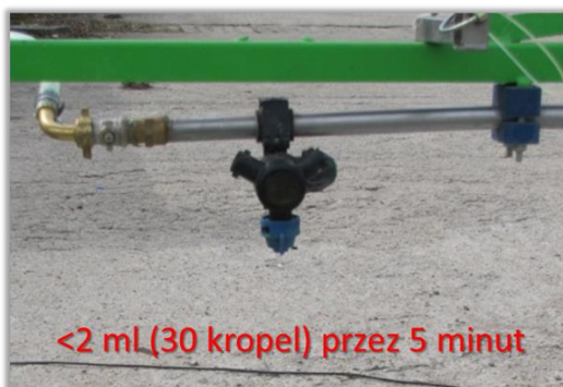
Rys. 72. Zawór przeciwkropłowy i dopuszczalny limit wycieku / kapania.
