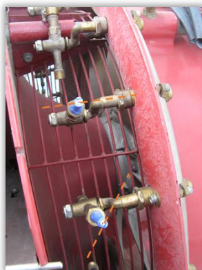
Rys. 121. Rozpylacze płaskostrumieniowe sadownicze nieprawidłowo ustawione - płaszczyzny strumieni cieczy przecinają się.
