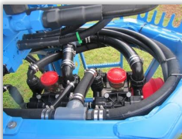
Rys. 16 i 17. Zbiornik wskaźnikowy poziomu oleju w pompie opryskiwacza (16) i pompy zespolone – każda z osobnym zbiornikiem (17).
