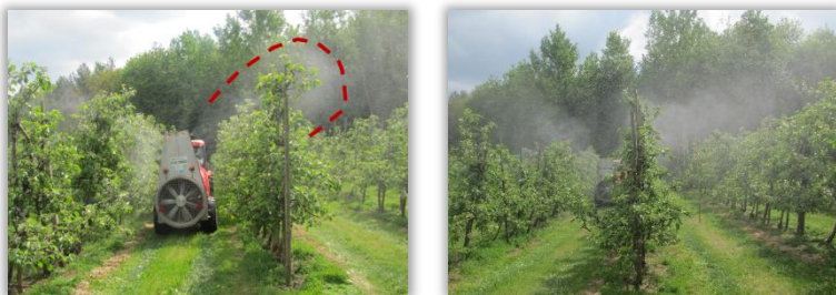
Rys. 132 i 133. Wydajność strumienia powietrza PRAWIDŁOWO dobrana – strumień dociera tylko do połowy sąsiedniego międzyrzędzia (132) i NIEPRAWIDŁOWO dobrana - dociera dalej niż do sąsiedniego rzędu (133).
