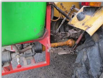
Rys. 3. Wałek prawidłowo osłonięty.
