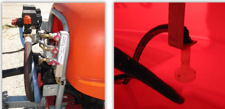
Rys. 106 i 107. Zawory sterujące zasilaniem układu płuczącego (106) i zraszacz we wnętrzu zbiornika opryskiwacza (107).
