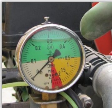
Rys. 53. Manometr z zaznaczonym zakresem drgań wskazówki.
