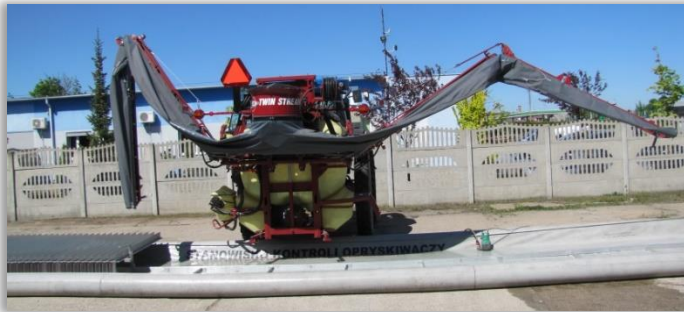
Rys. 65. Test automatycznego składania - rozkładania belki polowej.
