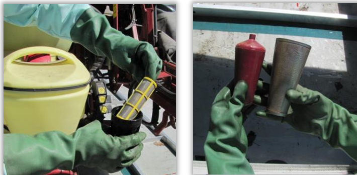
Rys. 60 i 61. Kontrola stanu technicznego i parametrów wkładu filtracyjnego.
