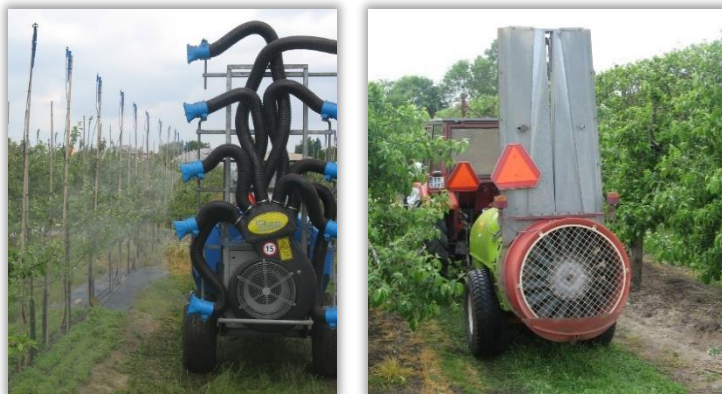
Rys. 128 i 129. Opryskiwacz z wentylatorem promieniowym (128) z indywidualnie kierowanymi strumieniami powietrza oraz z wentylatorem osiowym z deflektorem (129).
