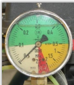
Rys. 49. Manometr zalecany do pracy w zakresie do 5 barów (0,5 MPa) z prawidłową działką elementarną – skala w MPa.
