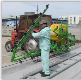
Rys. 63 i 64. Test ręcznego składania - rozkładania belki polowej.
