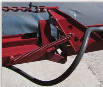
Rys. 92 i 93. Elementy wpływające na stabilność belki polowej – zawias (92) i sprężyna amortyzująca (93).
