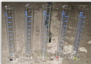
Rys. 163. Cylindry miarowe o pojemności 2000 ml, działce elementarnej 20 ml i dopuszczalnym błędzie granicznym pomiaru wynoszącym \pm 20 ml.
