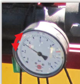
Rys. 70. Manometr z zaznaczonym zakresem drgań wskazówki.
