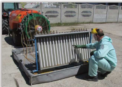
Rys. 142. Urządzenie do pomiaru natężenia wypływu cieczy z rozpylaczy zamontowanych na opryskiwaczu sadowniczym lub chmielarskim. Możliwy pomiar wypływu z 20 rozpylaczy jednocześnie.
