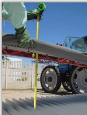
Rys. 126. Pomiar odległości (wysokość) rozpylaczy od górnej krawędzi rowka stołu rowkowego.
