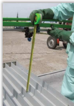
Rys. 129. Elektroniczny stół rowkowy w czasie pomiaru – włączone wszystkie rozpylacze na całej długości belki.
