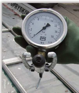
Rys. 160. Manometr do pomiaru ciśnienia roboczego w sekcjach belki polowej opryskiwacza polowego – typ 1, montowany bezpośrednio do rozpylacza.
