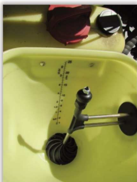
Rys. 61. Płuczka opakowań po środkach ochrony montowana w rozwadniaczu bocznym opryskiwacza.
