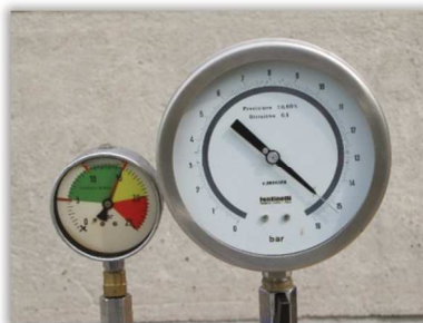
Rys. 74. Pomiar dokładności wskazań manometru na stanowisku kontrolnym przy ciśnieniu 10 barów.
