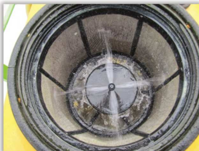
Rys. 55. Rozwadniacz zamontowany w sicie wlewowym zbiornika opryskiwacza.
