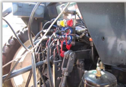
Rys. 8 i 9. Przewody cieczowe (8) i hydrauliczne opryskiwacza (9).
