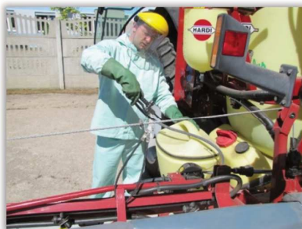
Rys. 59. Płukanie wnętrza rozwadniacza za pomocą specjalnej lancy.
