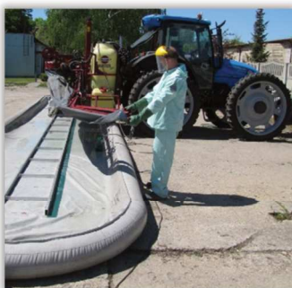
Rys. 107 i 108. Test mechanizmu automatycznego powrotu belki do położenia początkowego.
