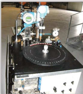
Rys. 136 i 137. Stanowisko do pomiaru natężenia wypływu cieczy z rozpylaczy zdemontowanych z opryskiwacza oraz mobilna stacja kontroli (Francja).
