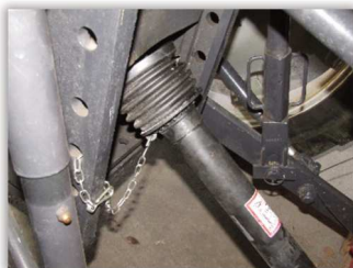
Rys. 3. Sposób przypięcia osłony wału do elementu stałego.
