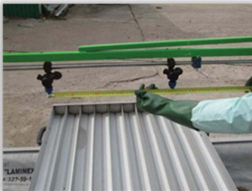
Rys. 104. Pomiar odległości między rozpylaczami zainstalowanymi na belce połowej opryskiwacza polowego za pomocą przymiaru wstęgowego.
