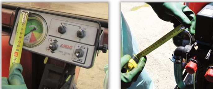
Rys. 63 i 64. Pomiar średnicy obudowy manometru.
