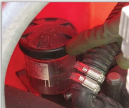
Rys. 19. Zbiornik wskaźnikowy poziomu oleju w pompie opryskiwacza.
