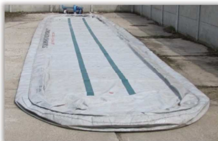
Rys. 162. Basen do zbierania wody w czasie pomiarów wykonywanych w Stacji Kontroli Opryskiwaczy.
