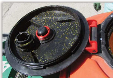
Rys. 32. Elementy ruchome zaworu napowietrzającego zbiornik.
