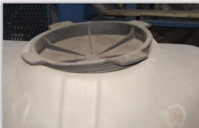
Rys. 30. Gumowa pokrywa zbiornika wciskana w otwór wlewowy.
