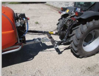
Rys. 1. Wał przegubowo-teleskopowy bez osłony.
