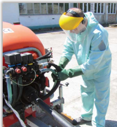
Rys. 82. Sprawdzanie jakości połączeń układu cieczowego w opryskiwaczu sadowniczym.
