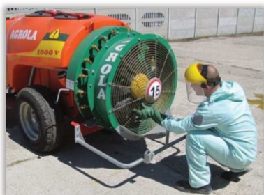
Rys. 145. Oględziny osłon i łopat wentylatora w opryskiwaczu sadowniczym.
