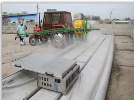
Rys. 129. Elektroniczny stół rowkowy w czasie pomiaru – włączone wszystkie rozpylacze na całej długości belki.
