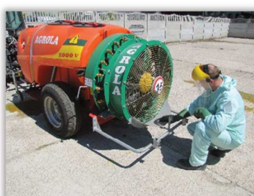
Rys. 16. Ściany zewnętrzne zbiornika – miejsca narażone na zanieczyszczenie.
