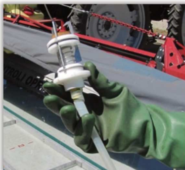
Rys. 135. Adapter umożliwiający szczelne połączenie rozpylacza z urządzeniem pomiarowym zbierającym ciecz.
