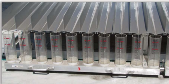
Rys. 128. Linie wyznaczające średnie napełnienie menzur i odchyłki o 15% "w górę" i "w dół" od tej wartości.
