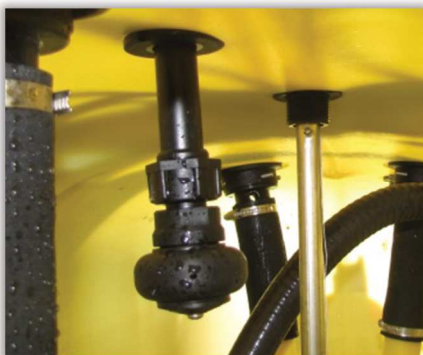
Rys. 48 i 49. Zraszacze do płukania wnętrza zbiornika.
