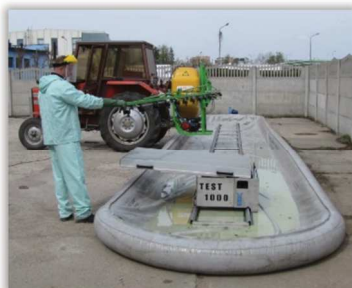
Rys. 105 i 106. Test mechanizmu automatycznego powrotu belki do położenia początkowego
