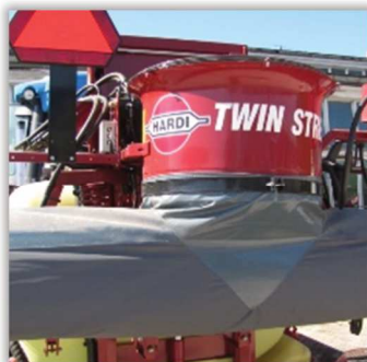
Rys. 149. Rękaw systemu pomocniczego strumienia powietrza w opryskiwaczu polowym.
