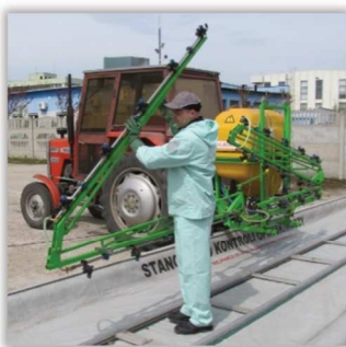
Rys. 94 i 95. Test ręcznego składania - rozkładania belki polowej.
