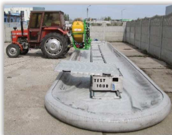
Rys. 157. Elektroniczny stół rowkowy z odczytem automatycznym.
