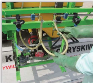
Rys. 8 i 9. Przewody cieczowe (8) i hydrauliczne opryskiwacza (9).
