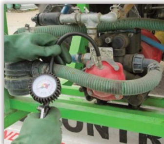
Rys. 20. Sprawdzenie ciśnienia w powietrzniku przy użyciu podręcznego manometru.
