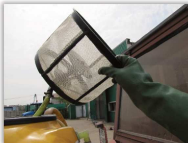
Rys. 37. Sito wlewowe bez rozwadniacza preparatów.
