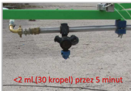
Rys. 110. Zawór przeciwkroplowy i dopuszczalny limit wycieku-kapania.
