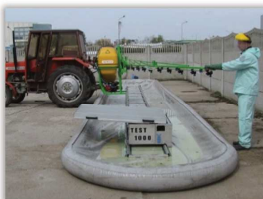
Rys. 105 i 106. Test mechanizmu automatycznego powrotu belki do położenia początkowego
