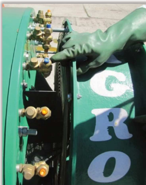
Rys. 139. Rozpylacze na opryskiwaczu sadowniczym mogą się różnić na jednej stronie, ale na odpowiadających sobie pozycjach po obu stronach opryskiwacza powinny być jednakowe.
