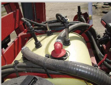
Rys. 16. Ściany zewnętrzne zbiornika – miejsca narażone na zanieczyszczenie.
