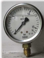
Rys. 67. Manometr z prawidłową działką elementarną – skala w barach.
