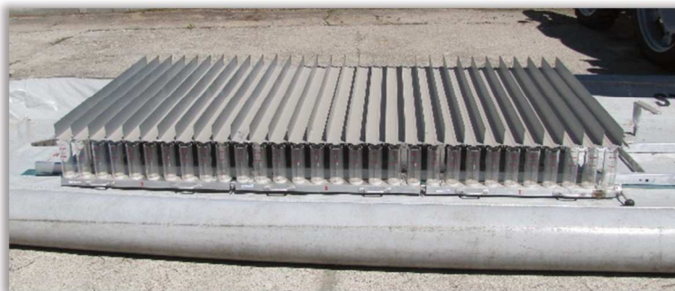
Rys. 156. Ręczny stół rowkowy z odczytem optycznym przez operatora.
