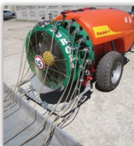
Rys. 142. Urządzenie do pomiaru natężenia wypływu cieczy z rozpylaczy zamontowanych na opryskiwaczu sadowniczym lub chmielarskim. Możliwy pomiar wypływu z 20 rozpylaczy jednocześnie.
