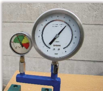
Rys. 74. Pomiar dokładności wskazań manometru na stanowisku kontrolnym przy ciśnieniu 10 barów.
