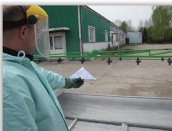
Rys. 116. Wizualna ocena kąta rozpylania i jednorodności rozpylaczy.
