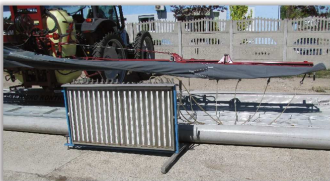
Rys. 134. Urządzenie do pomiaru natężenia wypływu cieczy z 20 rozpylaczy jednocześnie. Wyposażone jest w zestaw 20 menzur o pojemności 2000 ml połączonych w sposób umożliwiający jednocześnie rozpoczęcie lub zakończenie napełniania tych menzur.
