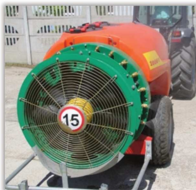
Rys. 140. Ocena kształtu strumienia cieczy w opryskiwaczu sadowniczym powinna być wykonana przy włączonym wentylatorze.
