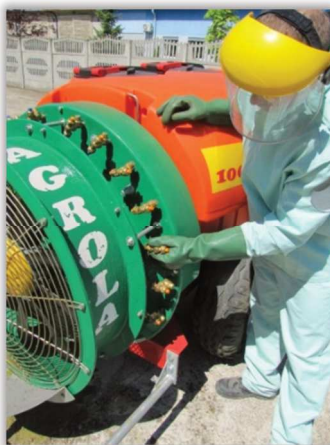
Rys. 111. Kontrola jakości zamocowania korpusów rozpylaczy do przewodów zasilających.
