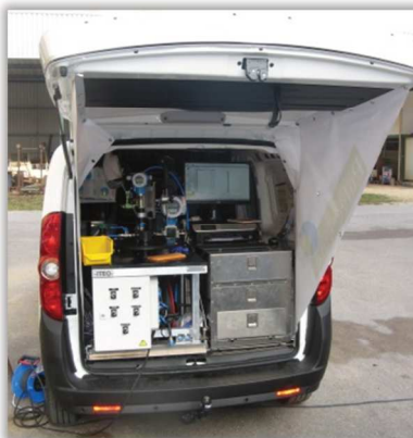
Rys. 136 i 137. Stanowisko do pomiaru natężenia wypływu cieczy z rozpylaczy zdemontowanych z opryskiwacza oraz mobilna stacja kontroli (Francja).
