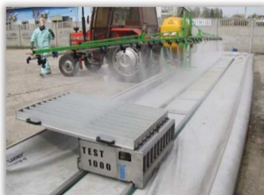
Rys. 157. Elektroniczny stół rowkowy z odczytem automatycznym.
