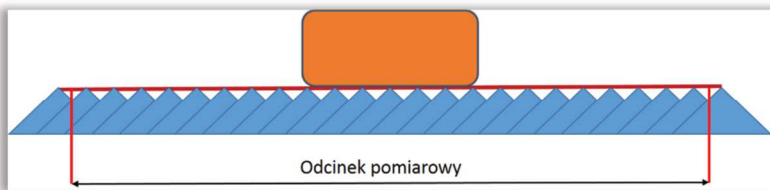
Rys. 125. Obszar, który należy uwzględnić przy ocenie nierównomierności rozkładu poprzecznego cieczy w metodach 2.8.3.1 i 2.8.3.2.
