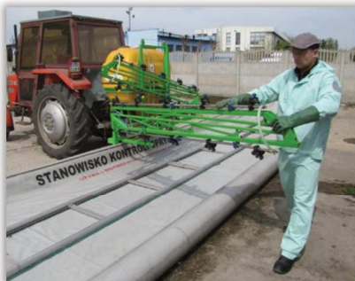
Rys. 94 i 95. Test ręcznego składania - rozkładania belki polowej.
