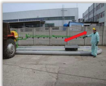
Rys. 90. Test stabilności belki polowej – odchylenie ramion w płaszczyźnie pionowej.
