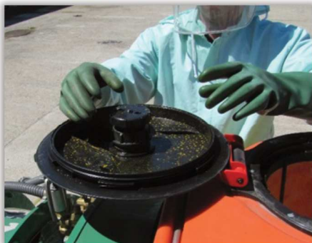
Rys. 31. Zawór napowietrzający zbiornika.
