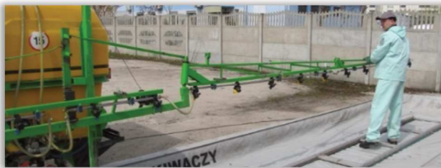
Rys. 109. Test układu amortyzacji i stabilizacji belki polowej.
