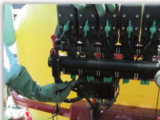
Rys. 78. Regulację zaworów kompensacyjnych opryskiwacza sadowniczego z oznaczeniem pozycji ustawienia zaworu.
