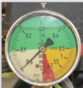
Rys. 65. Manometr zalecany do pracy w zakresie do 5 barów (0,5 MPa) z prawidłową działką elementarną – skala w MPa.
