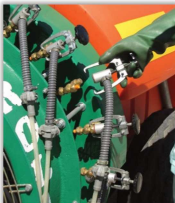
Rys. 144. Adapter umożliwiający pomiar natężenia wypływu cieczy z rozpylaczy.
