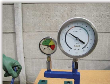
Rys. 72. Pomiar błędu ciśnienia wskazywanego przez manometr opryskiwacza na stanowisku kontrolnym wyposażonym w praskę hydrauliczną i manometr kontrolny.
