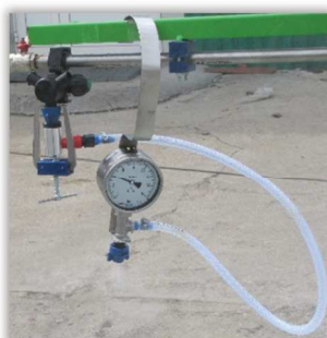
Rys. 160. Manometr do pomiaru ciśnienia roboczego w sekcjach belki polowej opryskiwacza polowego – typ 1, montowany bezpośrednio do rozpylacza.
