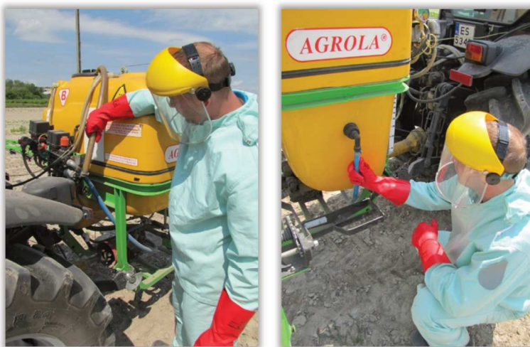
Rys. 80 i 81. Sprawdzenie jakości połączeń układu cieczowego w opryskiwaczu polowym.
