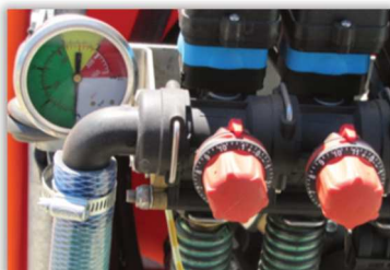
Rys. 78. Regulację zaworów kompensacyjnych opryskiwacza sadowniczego z oznaczeniem pozycji ustawienia zaworu.
