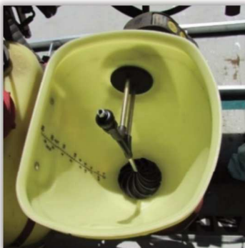
Rys. 57. Wnętrze zbiornika rozwadniacza bocznego.
