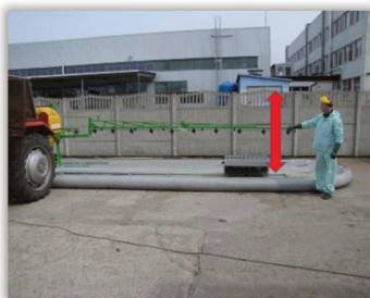
Rys. 90. Test stabilności belki polowej – odchylenie ramion w płaszczyźnie pionowej.
