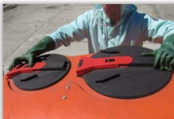
Rys. 28. Pokrywy zbiornika uszczelniane przez ich obrót.
