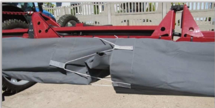
Rys. 150. Rękaw opryskiwacza polowego PSP - sposób ułożenia rękawa.
