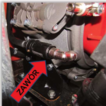
Rys. 24. Zawór bezpieczeństwa montowany bezpośrednio na wyjściu z pompy (opryskiwacz sadowniczy).
