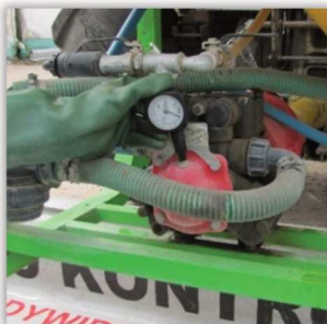
Rys. 20. Sprawdzenie ciśnienia w powietrzniku przy użyciu podręcznego manometru.
