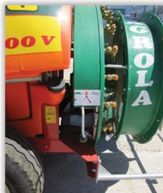
Rys. 145. Oględziny osłon i łopat wentylatora w opryskiwaczu sadowniczym.
