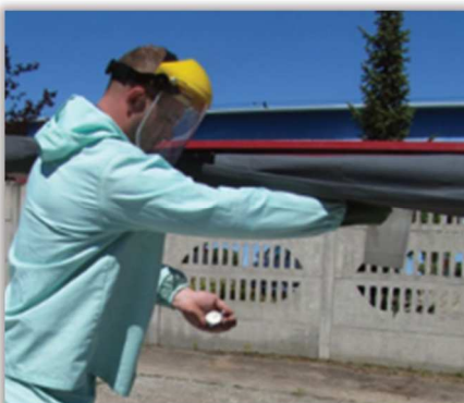
Rys. 126. Pomiar odległości (wysokość) rozpylaczy od górnej krawędzi rowka stołu rowkowego.
