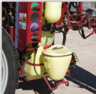
Rys. 55. Rozwadniacz zamontowany w sicie wlewowym zbiornika opryskiwacza.
