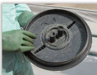
Rys. 28. Pokrywy zbiornika uszczelniane przez ich obrót.
