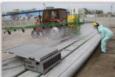
Rys. 116. Wizualna ocena kąta rozpylania i jednorodności rozpylaczy.
