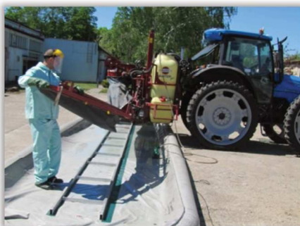
Rys. 107 i 108. Test mechanizmu automatycznego powrotu belki do położenia początkowego.
