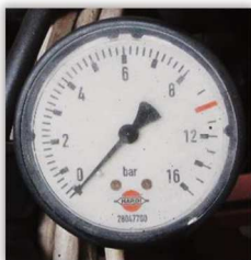
Rys. 67. Manometr z prawidłową działką elementarną – skala w barach.
