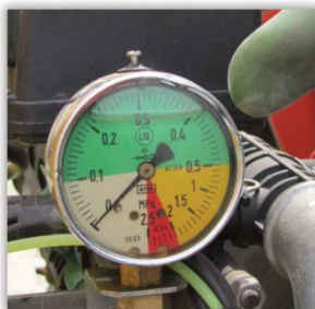
Rys. 70. Manometr z zaznaczonym zakresem drgań wskazówki.
