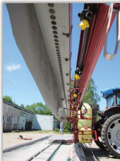
Rys. 118. Jednolite rozpylacze powinny mieć jednolite kołpaki dla ich łatwej identyfikacji.
