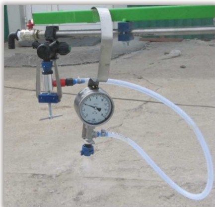
Rys. 138. Sposób zamontowania manometru kontrolnego do skrajnego rozpylacza.
