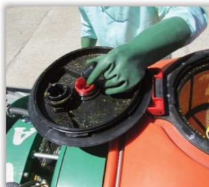
Rys. 32. Elementy ruchome zaworu napowietrzającego zbiornik.
