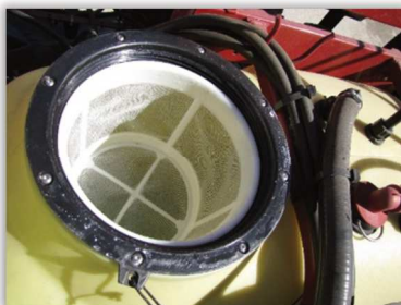
Rys. 37. Sito wlewowe bez rozwadniacza preparatów.
