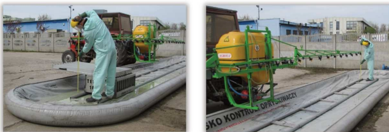
Rys. 102 i 103. Pomiar położenia belki polowej względem opryskiwanej powierzchni – pozycja pomiarowa nr 1 (102) i nr 2 (103).
