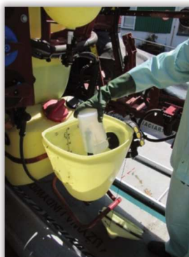
Rys. 61. Płuczka opakowań po środkach ochrony montowana w rozwadniaczu bocznym opryskiwacza.
