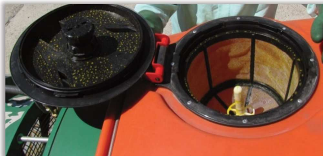
Rys. 60. Płuczka opakowań po środkach ochrony roślin montowana w sicie wlewowym opryskiwacza.
