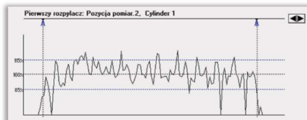
Rys. 133. Wykres rozkładu poprzecznego cieczy dla belki polowej opryskiwacza: Współczynnik zmienności CV=15,4\% przekracza zdecydowanie wartość dopuszczalną.
