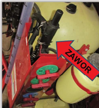
Rys. 24. Zawór bezpieczeństwa montowany bezpośrednio na wyjściu z pompy (opryskiwacz sadowniczy).
