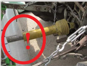
Rys. 1. Wał przegubowo-teleskopowy bez osłony.
