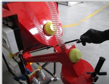
Rys. 91. Dźwignia zasowy opróżniania komory mieszania.
