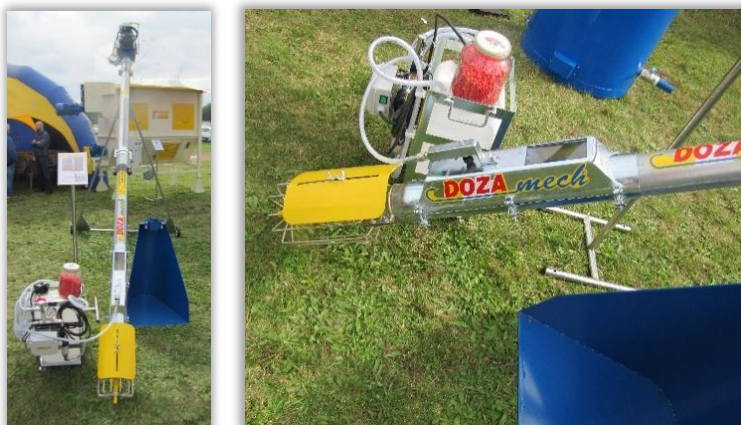
Rys. 32 i 33. Zaprawiarka montowana na przenośniku ślimakowym do zboża - podawanie zaprawy i zraszanie ciśnieniowe.
