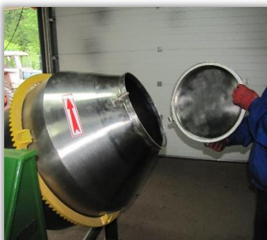
Rys. 24 i 25. Pokrywa zewnętrzna (24) i wewnętrzna (25) bębna zaprawiarki porcjowej.
