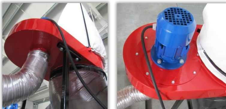
Rys. 70 i 71. Obudowa wentylatora urządzenia odpylającego – widok od dołu (70) i od góry (71) z silnikiem napędzającym wentylator.
