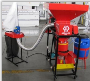
Rys. 60 i 61. System odpylania współpracujący z zaprawiarką porcjową (60) i przepływową (61).
