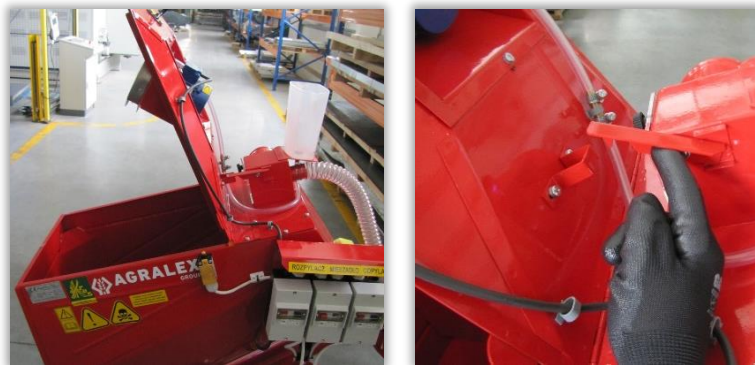
Rys. 20 i 21. Zamykana komora mieszania zaprawiarki porcjowej z rotacyjnym zraszczem (20) oraz jej zabezpieczenie w pozycji otwartej (21).
