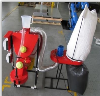
Rys. 60 i 61. System odpylania współpracujący z zaprawiarką porcjową (60) i przepływową (61).
