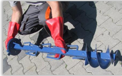
Rys. 87. Przenośnik ślimakowy wyjmowany z układu wylotowego zaprawiarki.
