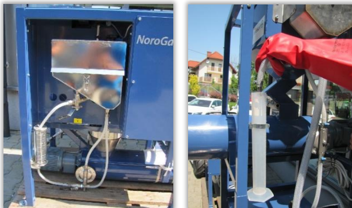
Rys. 28 i 29. Układ kalibracji i menzura kalibracyjna zaprawiarki przepływowej z czepakowym układem dozowania.
