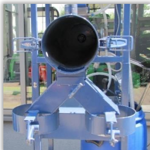
Rys. 76 i 77. Komora mieszania: sposób zamknięcia (82) i strefa opróżniania.
