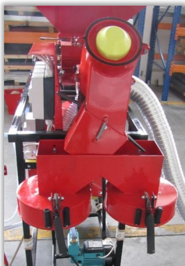
Rys. 93 i 94. Układ wylotowy zaprawiarki z workownicą dwudrożną – zwrotnica przepływu nasion skierowana w lewo (93) lub w prawo (94).
