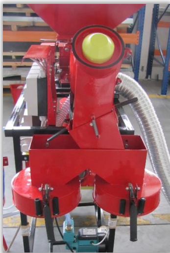
Rys. 93 i 94. Układ wylotowy zaprawiarki z workownicą dwudrożną – zwrotnica przepływu nasion skierowana w lewo (93) lub w prawo (94).
