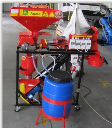
Rys. 51. Przewody cieczowe łączące układ czerpakowy ze zbiornikiem zaprawy. Rys. 52. Pompa zaprawiarki.
