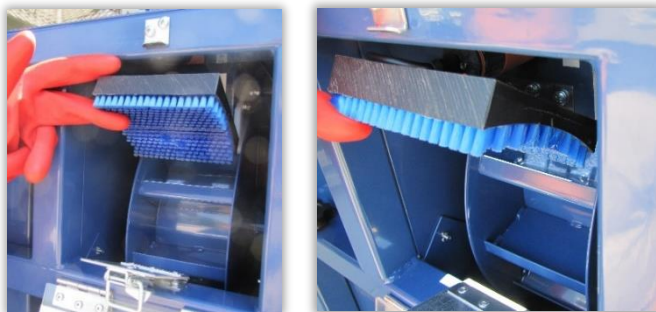
Rys. 36 i 37. Szczotki wyrównujące napełnienie komór porcjujących nasiona.
