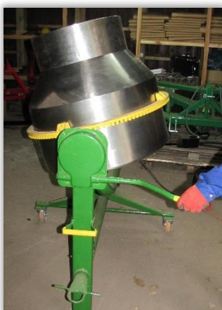
Rys. 95 i 96. Kontrola mechanizmu pochylania bębna w zaprawiarce porcjowej bębnowej.
