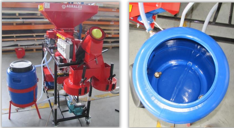
Rys. 97 i 98. Zbiornik zaprawy z przewodem powrotu zaprawy spełniającym rolę mieszadła.
