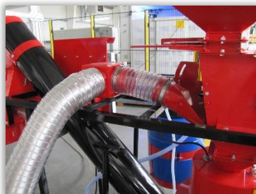
Rys. 66 i 67. Przewody przyłącza urządzenia odpylającego do komory odmierzania nasion i do urządzenia opróżniającego (67).
