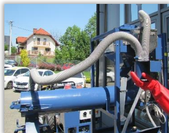
Rys. 62. Przewody łączące zaprawiarkę z urządzeniem odpylającym. Rys. 63. Otwór przyłącza urządzenia odpylającego do komory mieszania.
