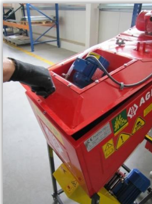
Rys. 78. Komora zraszania z grawitacyjnym spływem zaprawy - zaprawa jest „zabierana” przez nasiona na specjalnie ukształtowanej powierzchni.
