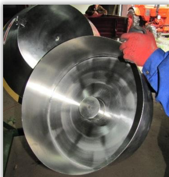
Rys. 24 i 25. Pokrywa zewnętrzna (24) i wewnętrzna (25) bębna zaprawiarki porcjowej.
