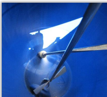
Rys. 58 i 59. Filtr ssawny (bliżej) zamocowany do sztywnego przewodu cieczowego (58) oraz filtr i mieszadło cieczi na dnie zbiornika zaprawy (59).
