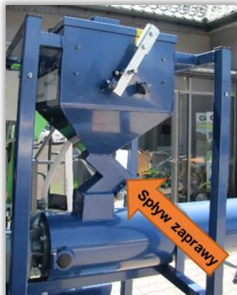
Rys. 78. Komora zraszania z grawitacyjnym spływem zaprawy - zaprawa jest „zabierana” przez nasiona na specjalnie ukształtowanej powierzchni.
