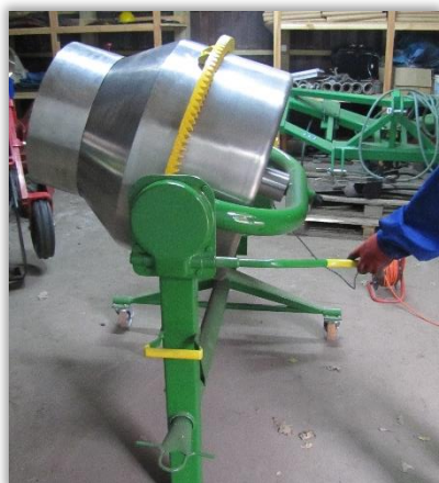
Rys. 95 i 96. Kontrola mechanizmu pochylania bębna w zaprawiarce porcjowej bębnowej.
