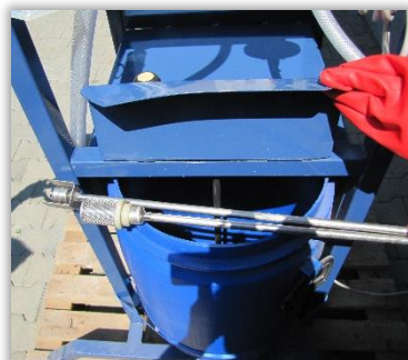
Rys. 58 i 59. Filtr ssawny (bliżej) zamocowany do sztywnego przewodu cieczowego (58) oraz filtr i mieszadło cieczi na dnie zbiornika zaprawy (59).
