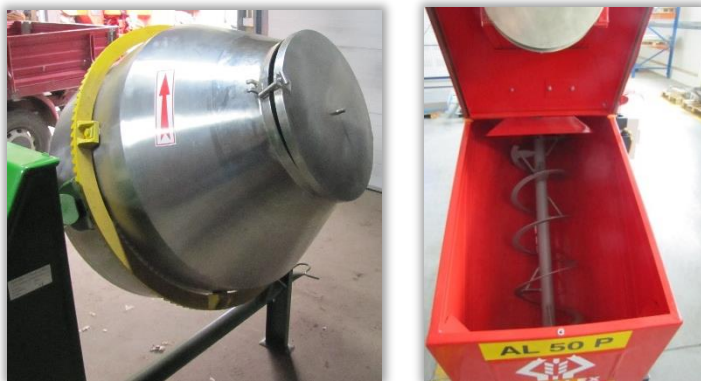
Rys. 72 i 73. Komory mieszania zaprawiarki porcjowej-bębnowej (72) i zaprawiarki porcjowej (73) z mieszalnikiem ślimakowym.
