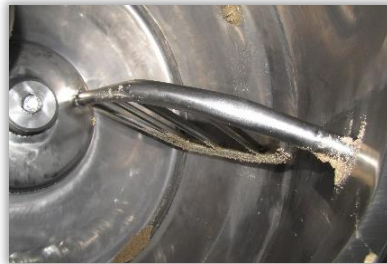
Rys. 101 i 102. Mieszadła o obłym kształcie we wnętrzu bębna zaprawiarki porcjowej.
