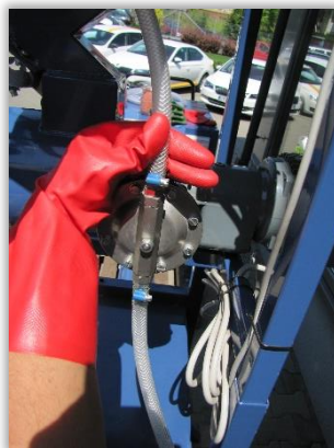
Rys. 51. Przewody cieczowe łączące układ czerpakowy ze zbiornikiem zaprawy. Rys. 52. Pompa zaprawiarki.
