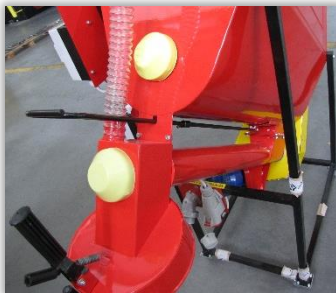
Rys. 91. Dźwignia zasowy opróżniania komory mieszania.
