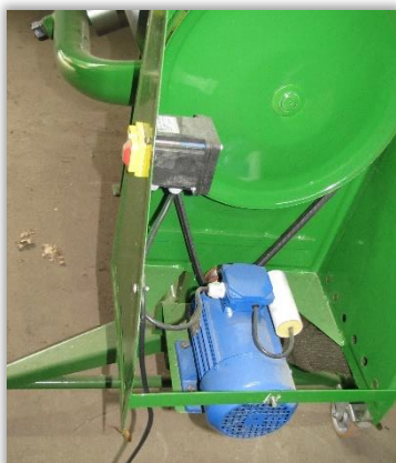
Rys. 18 i 19. Silnik elektryczny napędzający bęben zaprawiarki bębnowej (18), lub napędzający rozpylacz rotacyjny zaprawiarki porcjowej (19).
