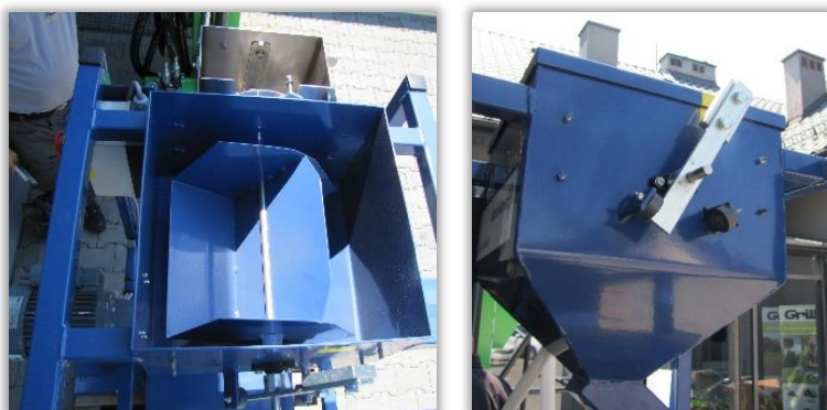
Rys. 30 i 31. Wahadłowy układ odmierzania nasion (30) i zewnętrzny wskaźnik ruchów tego układu (31).
