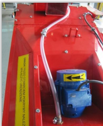
Rys. 18 i 19. Silnik elektryczny napędzający bęben zaprawiarki bębnowej (18), lub napędzający rozpylacz rotacyjny zaprawiarki porcjowej (19).
