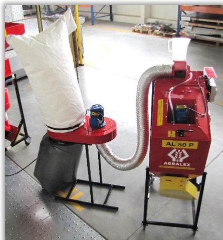
Rys. 4. Zaprawiarka porcjowa i dedykowany system odpylania.
