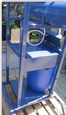
Rys. 13. Zbiornik zaprawy zamocowany na ramie zaprawiarki.
