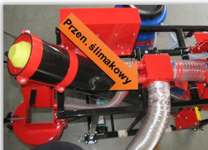
Rys. 85. Komora mieszania ze znajdującym się w jej wnętrzu (tu niewidocznym) przenośnikiem ślimakowym zaprawiarki przepływowej.
