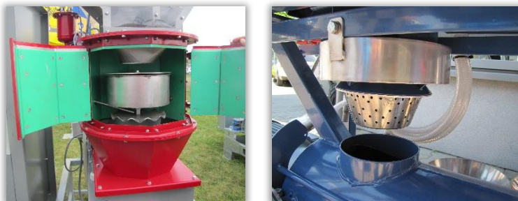
Rys. 53 i 54. Komora zraszania zaprawiarki przepływowej z otwartą osłoną (53) i ze zdemontowaną osłoną (54).
