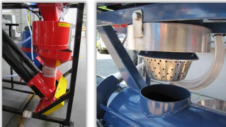
Rys. 74 i 75. Komory zraszania z rotacyjnym elementem zraszającym: uchylona osłona (74) i wnętrze komory po zdjęciu osłony (75).
