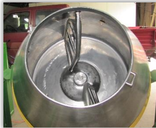
Rys. 101 i 102. Mieszadła o obłym kształcie we wnętrzu bębna zaprawiarki porcjowej.
