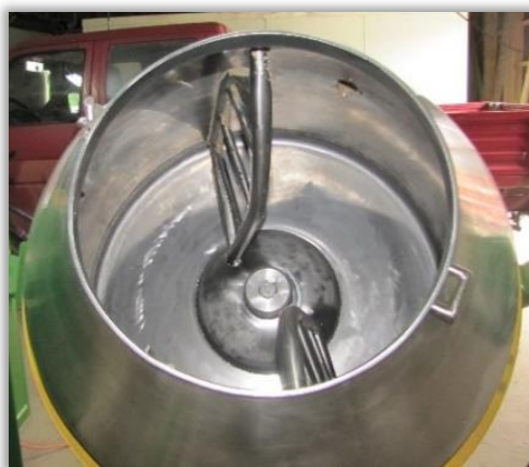
Rys. 7. Mieszadła zaprawiarki bębnowej widoczne przez otwór zasypowy.
