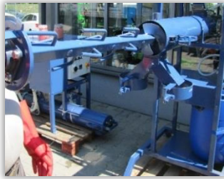
Rys. 87. Przenośnik ślimakowy wyjmowany z układu wylotowego zaprawiarki.
