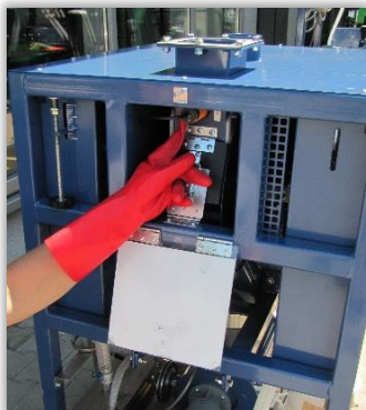
Rys. 44. Miejsce zamontowania bezpiecznika wyłączającego przepływ zaprawy.
