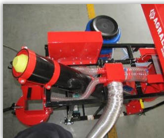
Rys. 66 i 67. Przewody przyłącza urządzenia odpylającego do komory odmierzania nasion i do urządzenia opróżniającego (67).
