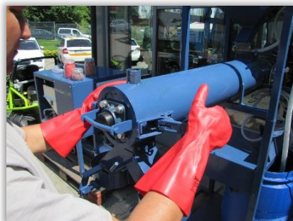
Rys. 76 i 77. Komora mieszania: sposób zamknięcia (82) i strefa opróżniania.
