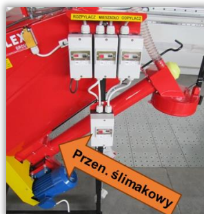
Rys. 85. Komora mieszania ze znajdującym się w jej wnętrzu (tu niewidocznym) przenośnikiem ślimakowym zaprawiarki przepływowej.
