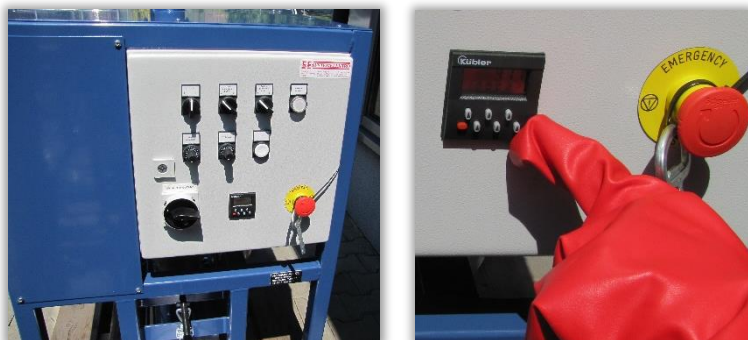
Rys. 49 i 50. Licznik cykli podawania nasion umieszczony na tablicy rozdzielczej zaprawiarki przepływowej.
