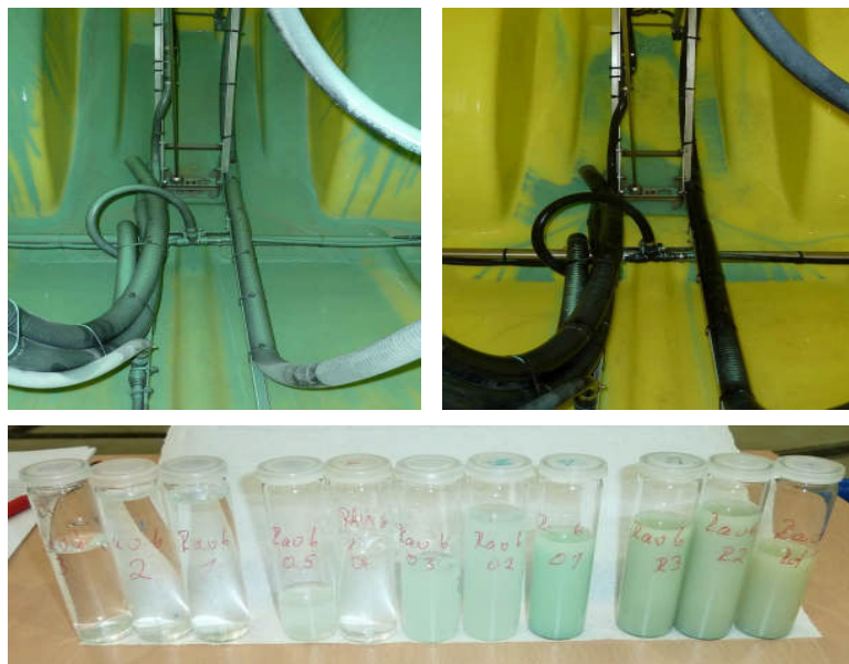
Rys. 3 Ocena efektywności wewnętrznego mycia opryskiwaczy: zbiornik przed i po myciu oraz próbki z tlenochlorkiem miedzi – od prawej: ciecz, kolejne etapy mycia, pozostałość w wodzie po kolejnym napełnieniu zbiornika (ISO 22358 -1: 2004)
