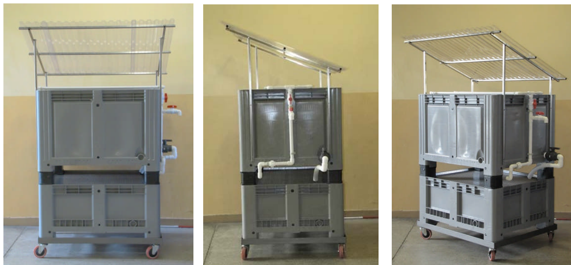
Rys. 1 Stanowisko bioremediacyjne Phytobac-IO
