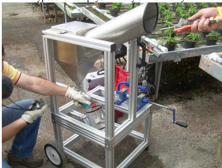
Fot. 1. Stanowisko do badania stanu technicznego lanc opryskowych stanowiących wyposażenie opryskiwaczy szklarniowych.
