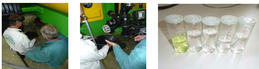
Rys. 3 Ocena efektywności wewnętrznego mycia opryskiwaczy: zbiornik przed i po myciu oraz próbki z tlenochlorkiem miedzi – od prawej: ciecz, kolejne etapy mycia, pozostałość w wodzie po kolejnym napełnieniu zbiornika (ISO 22358 -1: 2004)
