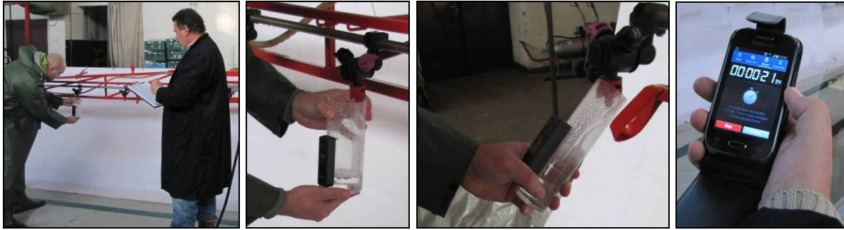
Rys. 12-15. Przepływomierze SprayTest-45 i Spraytest-75 - sposób wykonywania pomiaru natężenia wypływu cieczy i czasu wykonywania poszczególnych czynności.
