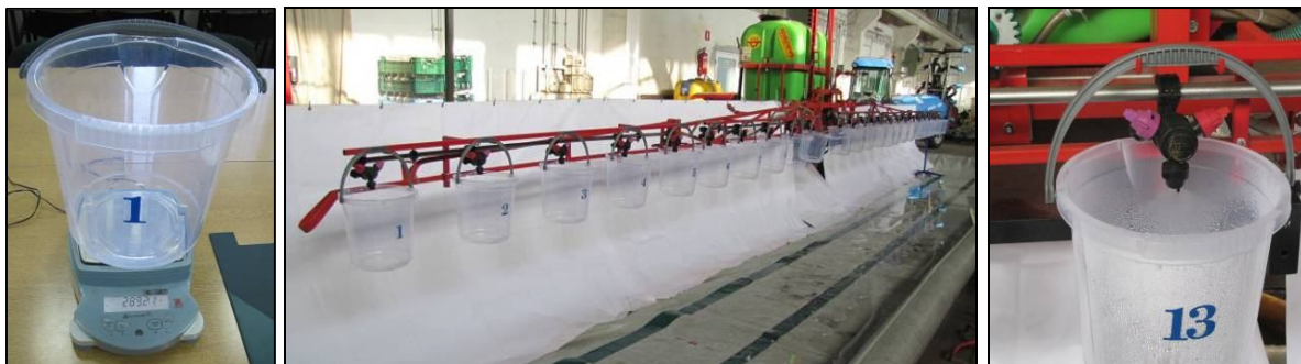
Rys. 1-3. Wiaderka o pojemności 10 l stosowane w metodzie wagowej i objętościowej: ważenie wiaderka, wiaderka na belce opryskiwacza i sposób zawieszenia wiaderka na belce na specjalnym stelażu.
