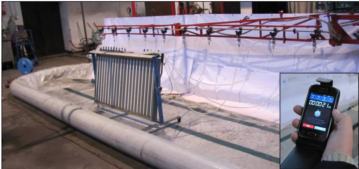
Rys. 7. Stanowisko do pomiaru natężenia wypływu cieczy za pomocą zestawu menzur pomiarowych SCHACHTNER (20 menzur o poj. 2000 ml dokładność 20 ml) .
