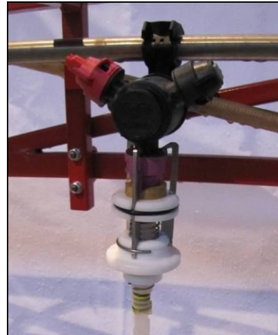
Rys. 8-9. Adaptery HERBST do odbierania cieczy z rozpylaczy na belce opryskiwacza, zestaw menzur SCHACHTNER, adapter HERBST (Prüftechnik Ernst Herbst, Unterachtel 14-16, D-92275 Hirschbach).
