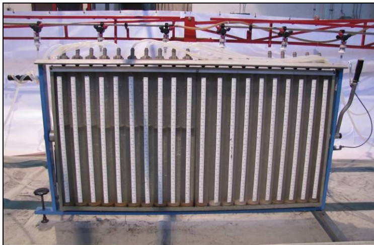
Rys. 8-9. Adaptery HERBST do odbierania cieczy z rozpylaczy na belce opryskiwacza, zestaw menzur SCHACHTNER, adapter HERBST (Prüftechnik Ernst Herbst, Unterachtel 14-16, D-92275 Hirschbach).
