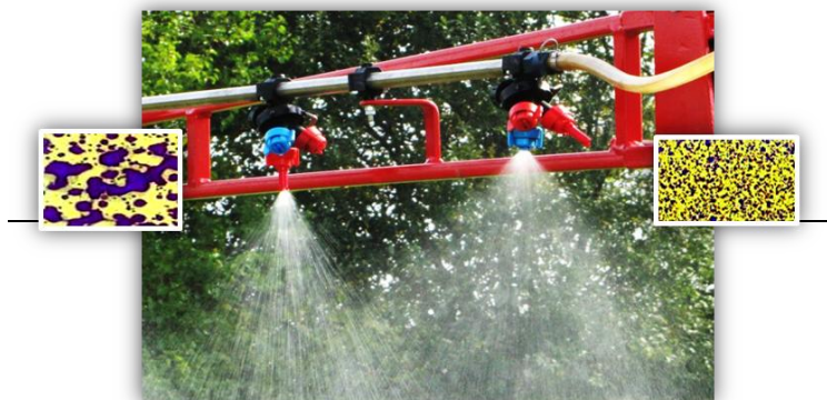
Rys. 9. Rozpylacze płaskostrumieniowe: eżektorowy (z lewej), standardowy (z prawej)
