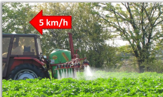
Rys. 22. Nadmierna prędkość robocza zwiększa efekt znoszenia
