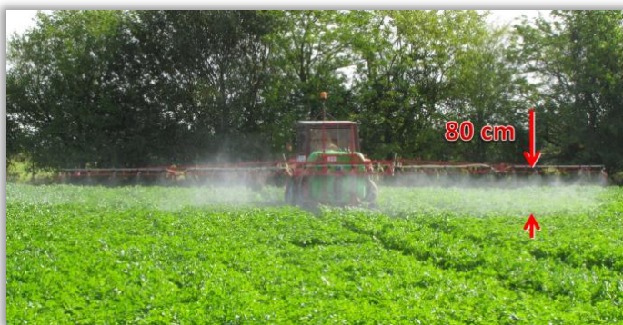
Rys. 23. Nadmierna wysokość belki polowej zwiększa efekt znoszenia
