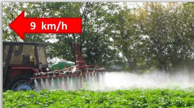
Rys. 22. Nadmierna prędkość robocza zwiększa efekt znoszenia
