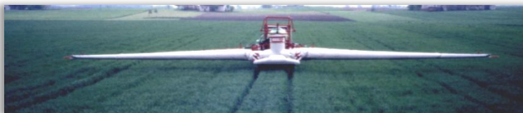
Rys. 19. Belka PSP – wentylator włączony
