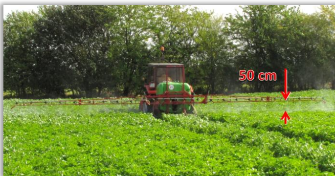
Rys. 23. Nadmierna wysokość belki polowej zwiększa efekt znoszenia
