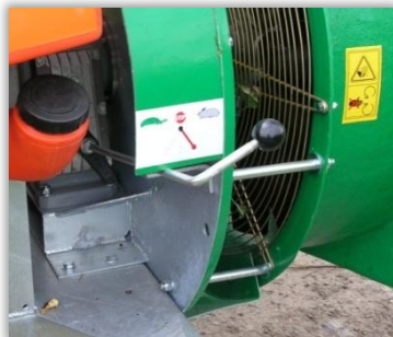
Rys. 20. Sposób regulacji strumienia powietrza: a) zmiana kąta natarcia łopatek wirnika; b) zmiana przełożenia przekładni wirnika
