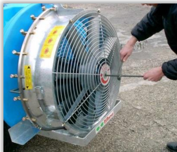
Rys. 20. Sposób regulacji strumienia powietrza: a) zmiana kąta natarcia łopatek wirnika; b) zmiana przełożenia przekładni wirnika
