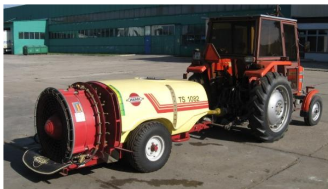
Fot. 3. Opryskiwacz Hardi TS 1082 podczas pomiarów zapotrzebowania mocy.
