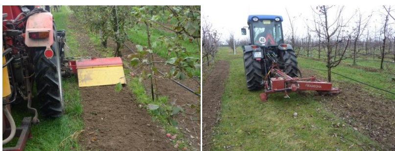
Fot. 15. Chwastowniki sadownicze podczas pomiarów od lewej: boczna i uchylna
