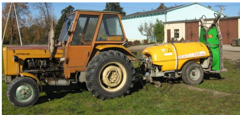
Fot. 6. Opryskiwacz Agrola 1000 eco podczas pomiarów zapotrzebowania mocy.
