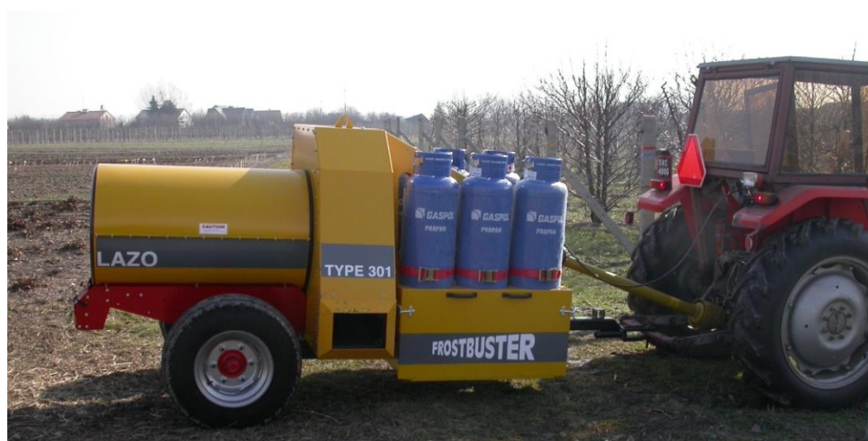
Fot. 17. Urządzenie Frost Buster podczas pomiarów zapotrzebowania mocy.
