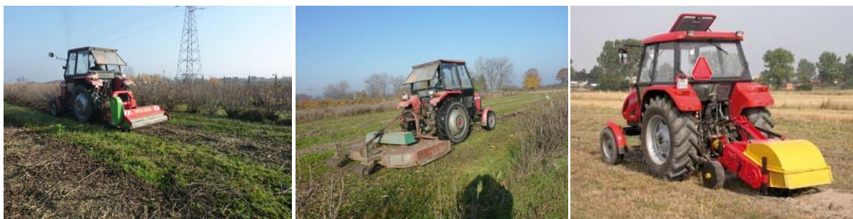
Fot. 13. Pomiary zapotrzebowania mocy podczas rozdrabniania części nadziemnych porzeczeki od lewej kosiarka bijakowa, kosiarka nożowa i karczownik.
