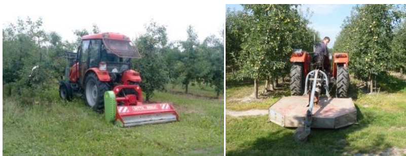
Fot. 9. Kosiarki bijakowa i nożowa podczas pomiarów zapotrzebowania mocy.
