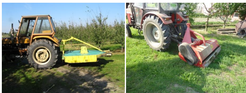
Fot. 11. Pomiary zapotrzebowania mocy dla kosiarki (od lewej) nożowej i bijakowej
