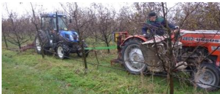
Fot. 16. Pomiar oporów toczenia maszyny uchylniej
