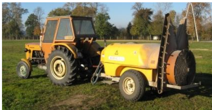
Fot. 5. Opryskiwacz Śleza Milenium 1500 podczas pomiarów zapotrzebowania mocy
