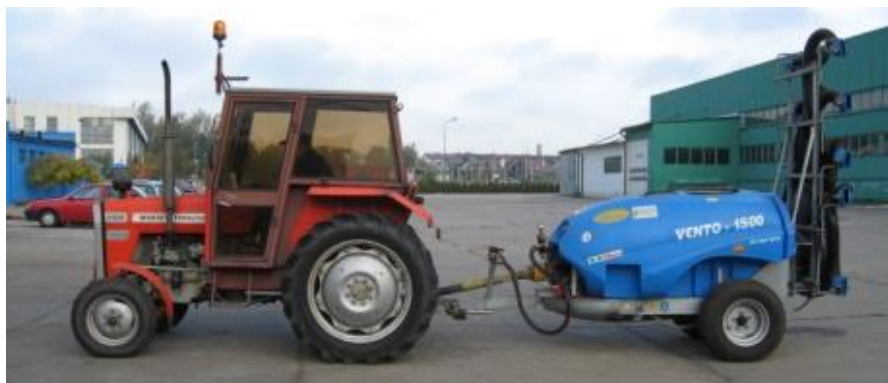
Fot. 7. Opryskiwacz Tifone Vento 1500 podczas pomiarów zapotrzebowania mocy.
