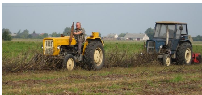
Fot. 14. Pomiary oporów toczenia podczas rozdrabniania części nadziemnych porzeczeki kosiarką bijakową.
