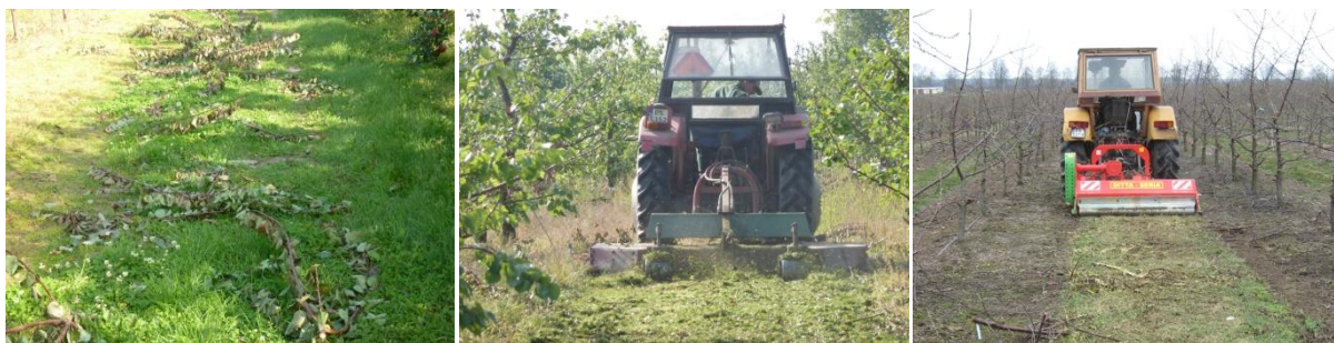
Fot. 12. Pomiary poboru mocy podczas rozdrabniania gałęzi po ciecju drzew kosiarką nożową.
