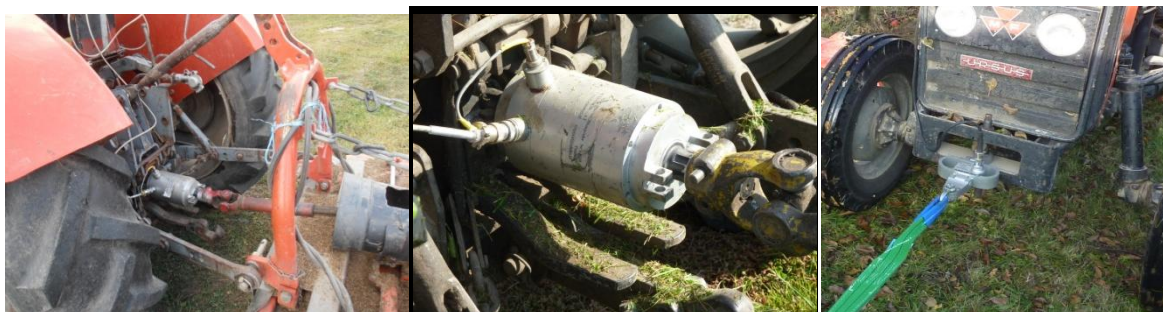
Fot. 1. Czujnik momentu obrotowego i prędkości kątowej na WOM oraz siły niezbędnej do pokonania oporów toczenia.
