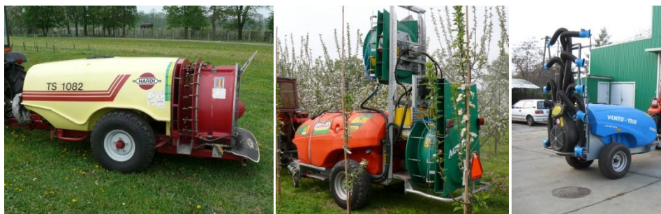
Fot. 2. Rodzaje opryskiwaczy od lewej: konwencjonalny, deflektorowy, z ukierunkowanym strumieniem powietrza.
