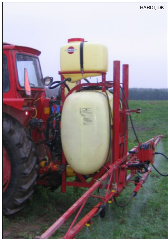
Rys. 10. Zestaw do mycia wewnętrznego do zamontowania na opryskiwaczu.
