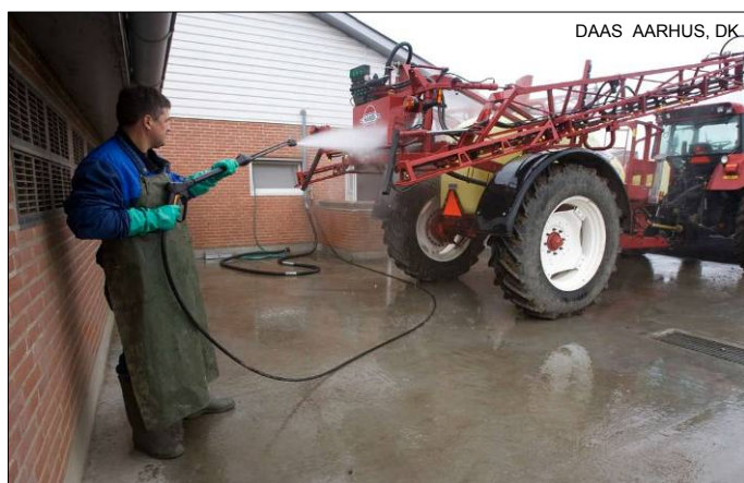
Rys.2. Stanowisko do mycia zewnętrznego opryskiwacza, umożliwiające zbieranie skażonej wody do zamkniętego zbiornika lub odprowadzania do systemu bioremediacji
