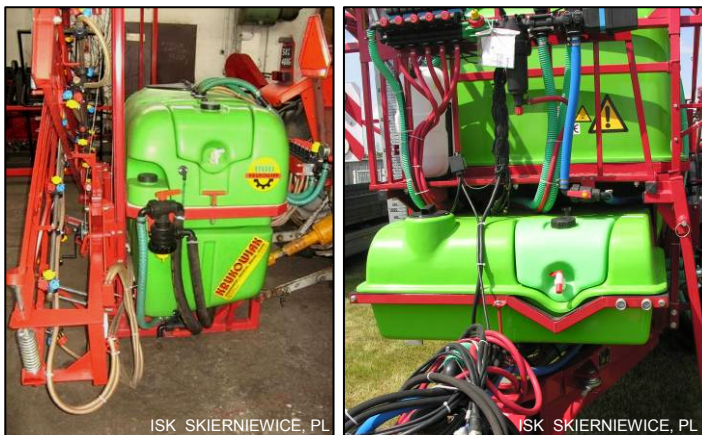
Rys. 15. Opryskiwacze ze zbiornikiem na czystą wodę.
