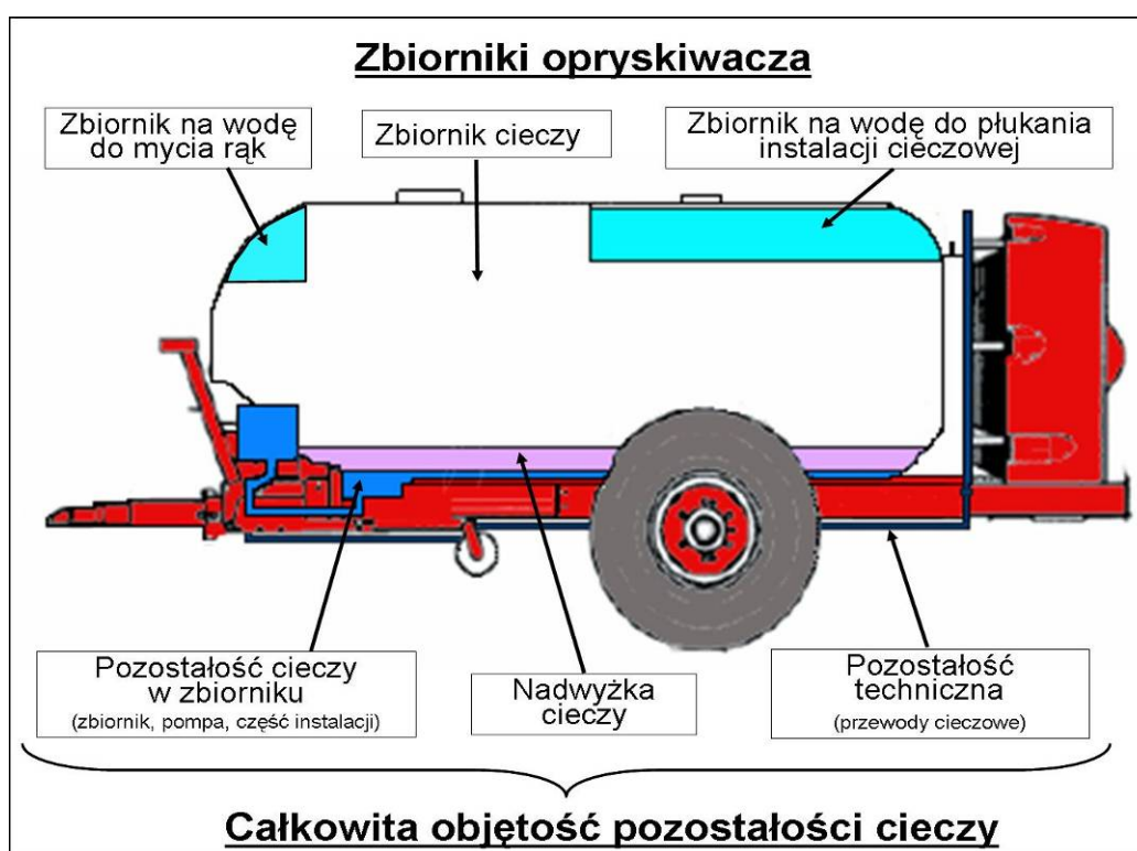
Rys. 5. Całkowita objętość pozostałości cieczy w opryskiwaczu zależy od dokładności jego kalibracji i konstrukcyjnego rozwiązania instalacji cieczowej.
