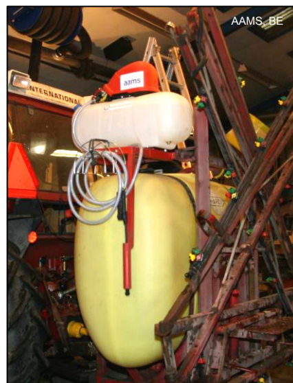
Rys. 16. Zestaw do mycia metodą ciągłą na opryskiwaczu polowym.
