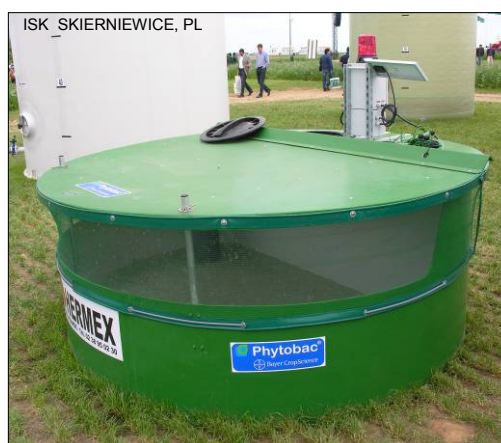
Rys.3. Urządzenie Phytoback do bioremediacji wody skażonej środkami ochrony roślin (np. popłuczyn po zewnętrznym myciu opryskiwacza)
