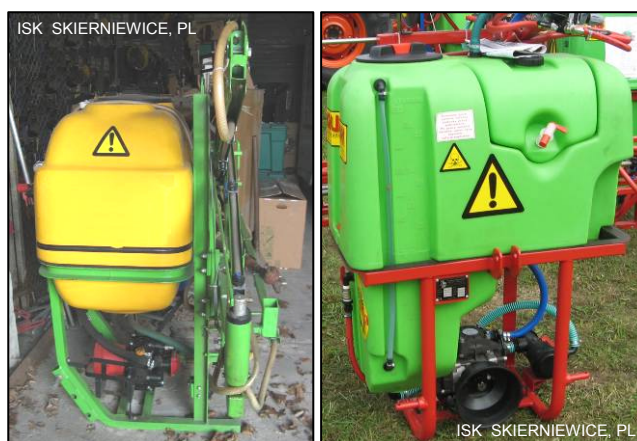
Rys. 14. Opryskiwacze bez zbiornika na czystą wodę do płukania instalacji cieczowej.
