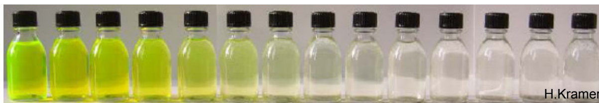
Rys. 12. Próbkki rozcieńczonej cieczy użytkowej pobrane z rozpylaczy od początku do zakończenia płukania instalacji cieczowej opryskiwacza metodą ciągłą.
