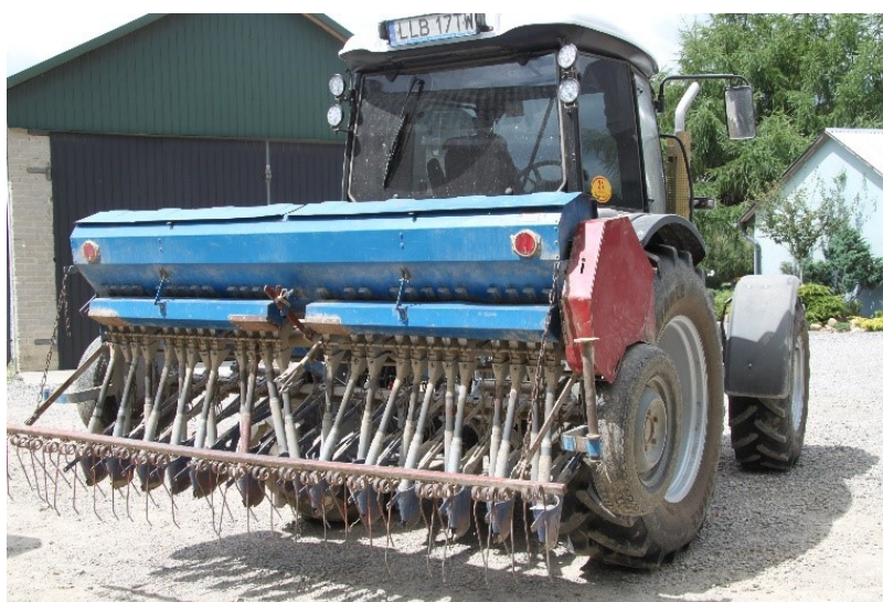
Fot. 13. Siewnik ciągnikowy, którym aplikowano inokulum grzybów entomopatogenicznych – B.bassiana
