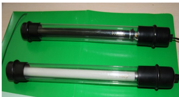
Fot. 2. Lampy typu świetlówka UV emitująca czarne (na górze), białe (na dole), zasilanie 12V zastosowane w pułapkach
