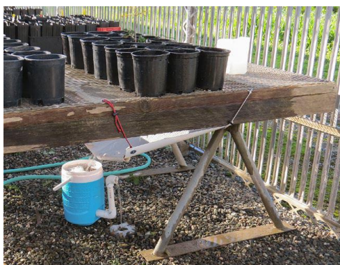
Fot. 1. Zbiornik – pułapka do wychwytywania zoospor Phytophthora spp. z wody, która została wykorzystana do podlewania roślin w szkółce
