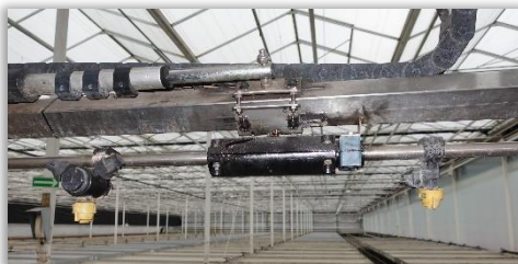
Rys. 66. Mechanizm regulacji kierunku ustawienia rozpylaczy – spiralna prowadnica zamontowana do belki zamienia ruch posuwisty siłownika na obrotowy ruch belki z rozpylaczami.
