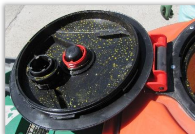
Rys. 26. Elementy ruchome zaworu napowietrzającego zbiornika.
