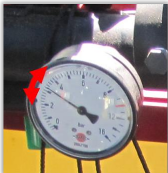
Rys. 39. Manometr z zaznaczonym zakresem drgań wskazówki.
