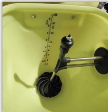
Rys. 51. Płuczka opakowań po środkach ochrony montowana w rozwadniaczu bocznym opryskiwacza.
