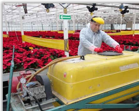
Rys. 16. Pokrywa zbiornika uszczelniane przez ich obrót.
