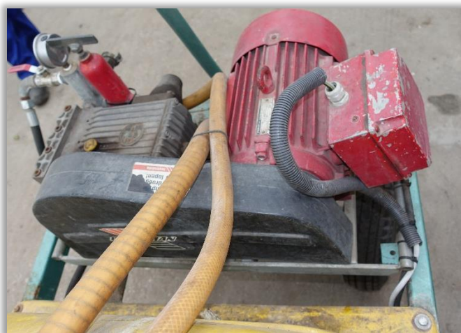
Rys. 3. Osłona napędu pompy - napęd od silnika elektrycznego.
