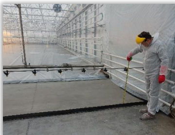
Rys. 58 i 59. Pomiar odległość pionowej pomiędzy dolnymi krawędziami skrajnych rozpylaczy i poziomą linią odniesienia na poziomej powierzchni.
