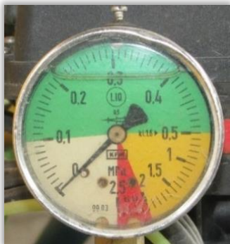
Rys. 36. Manometr zalecany do pracy w zakresie do 5 barów (0,5 MPa).
