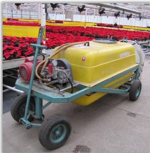
Rys. 4. Zbiornik na ciecz użytkową zamontowany na wspólnej ramie z pompą – wykorzystano tu opryskiwacz ciśnieniowy.
