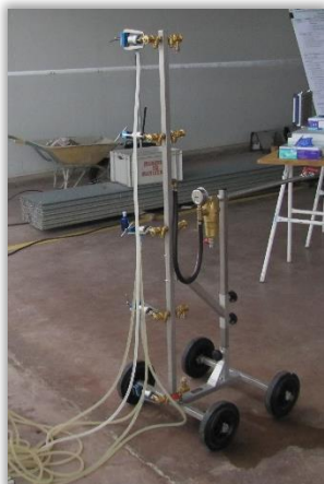
Rys. 79. Pionowa belka opryskowa z rozpylaczami skierowanymi na dwie strony – na rozpylacze założone są adaptory odbierające ciecz.
