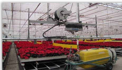
Rys. 46. Urządzenie do zwijania przewodu dostarczającego ciecz do belki opryskowej.
