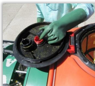
Rys. 27. Sprawdzanie drożności zaworu napowietrzającego.
