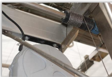
Rys. 63. Rolka nawijania linki mechanizmu ręcznej regulacji wysokości belki opryskowej.
