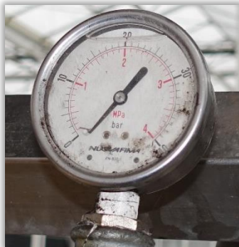
Rys. 37. Manometr o zakresie wskazań do 40 barów (4 MPa).
