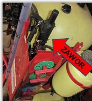
Rys. 34. Zawór bezpieczeństwa montowany w bezpośrednim sąsiedztwie układu zaworów (opryskiwacz polowy).
