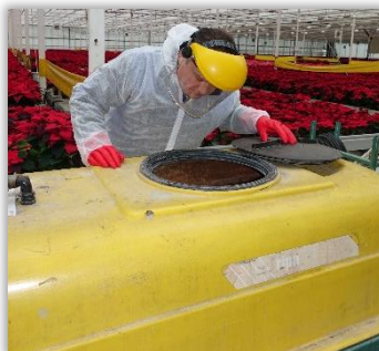
Rys. 25. Obserwacja jakości mieszania wewnątrz zbiornika.
