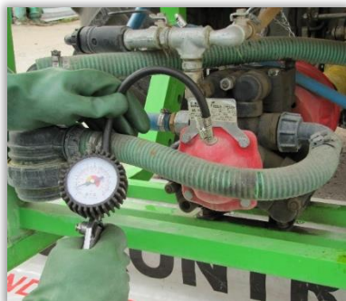
Rys. 31. Sprawdzenie ciśnienia w powietrzniku za pomocą manometru zamontowanego na przewodzie ciśnieniowym pompki lub sprężarki.
