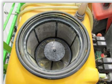
Rys. 19. Sito z rozkadłobieniem preparatów w otworze wlewowym opryskiwacza.
