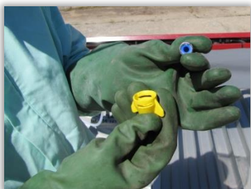
Rys. 74. Filtr rozpylacza - typ 2, rozmiar 2.
