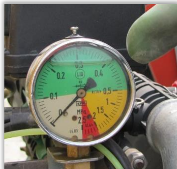
Rys. 40. Manometr glicerynowy - wskazówka jest zanurzona w glicerynie tłumiącej drgania.
