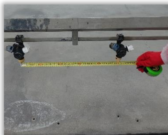
Rys. 69 i 70. Pomiar odległości między rozpylaczami na belce.
