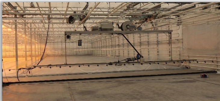
Rys.2. Opryskiwacz szklarniowy częściowo mobilny (ruchomy element opryskujący).
