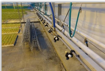
Rys. 65. Pozycja spoczynkowa belki nawodnieniowo-opryskowej przy ścianie szklarni.
