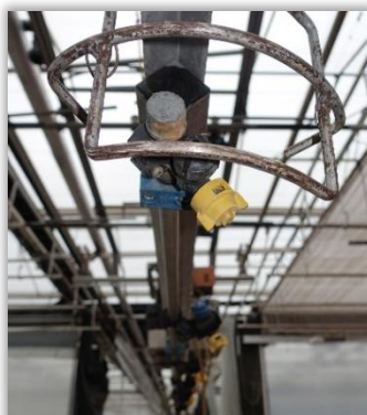
Rys. 67 i 68. Rozpylacze skierowane do tyłu lub do przodu względem kierunku jazdy belki – wykorzystany mechanizm regulacji kierunku rozpylaczy.
