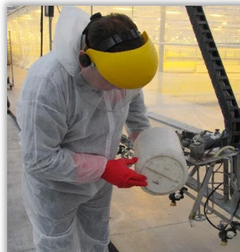
Rys. 10. Oględziny zbiornika na środek ochrony roślin – system iniekcyjny.
