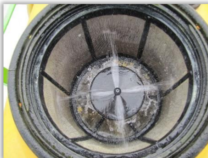
Rys. 48. Rozwadniacz zamontowany w sicie wlewowym zbiornika opryskiwacza.
