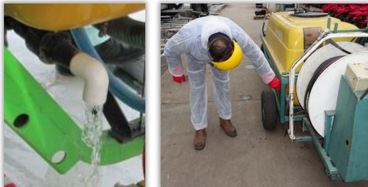
Rys. 21 i 22. Zawór spustowy układu opróżniania opryskiwacza i potencjalne umiejscowienie zaworu w zbiorniku opryskiwacza.
