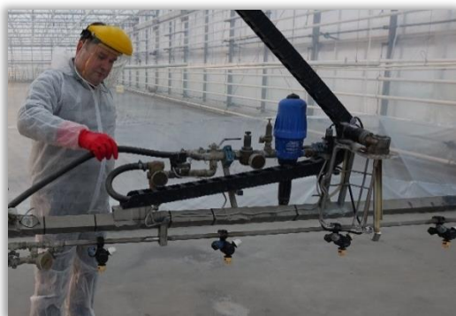
Rys. 6. Przewody cieczowe opryskiwacza szklarniowego.
