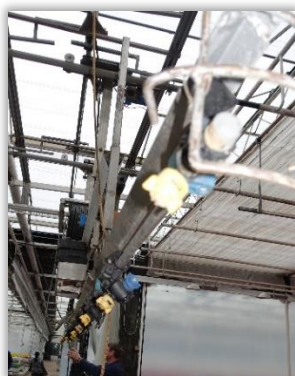
Rys. 67 i 68. Rozpylacze skierowane do tyłu lub do przodu względem kierunku jazdy belki – wykorzystany mechanizm regulacji kierunku rozpylaczy.
