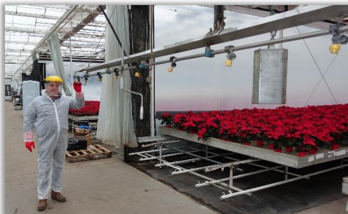
Rys. 60. Test stabilności belki opryskowej.
