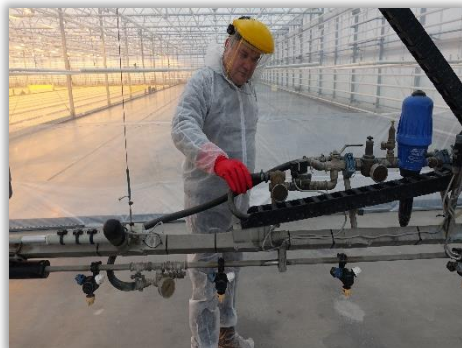
Rys. 45. Sprawdzenie jakości połączeń układu cieczowego w opryskiwaczu szklarniowym.
