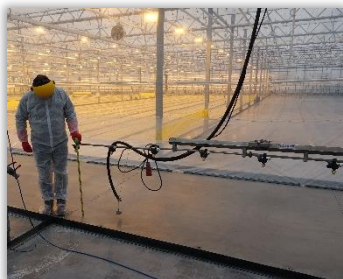
Rys. 58 i 59. Pomiar odległość pionowej pomiędzy dolnymi krawędziami skrajnych rozpylaczy i poziomą linią odniesienia na poziomej powierzchni.
