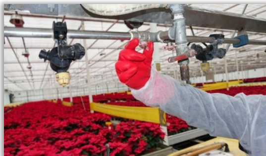
Rys. 41. Zawór odcinający dopływ cieczy do części belki opryskowej.
