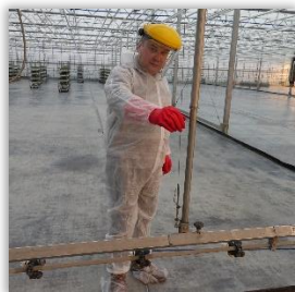
Rys. 62. Kontrola stanu linki wyciągarki ręcznego mechanizmu regulacji wysokości belki opryskowej.
