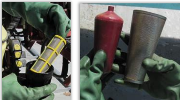
Rys. 54 i 55. Kontrola stanu technicznego i parametrów wkładu filtracyjnego.
