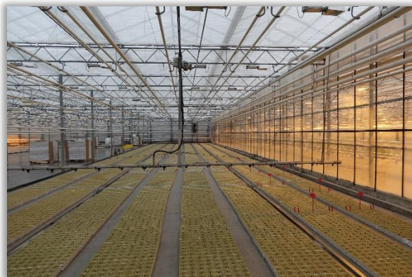
Rys. 56. Belka opryskowa zachowująca poziome ustawienie.
