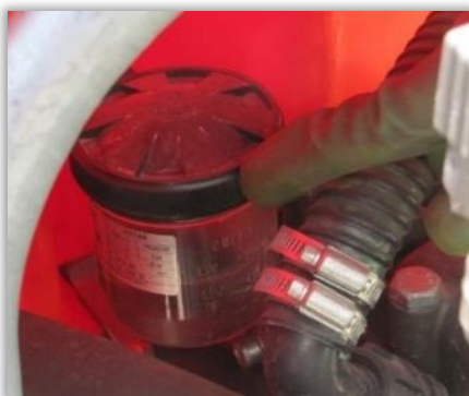
Rys. 30. Zbiornik wskaźnikowy poziomu oleju w pompie przeponowej opryskiwacza.
