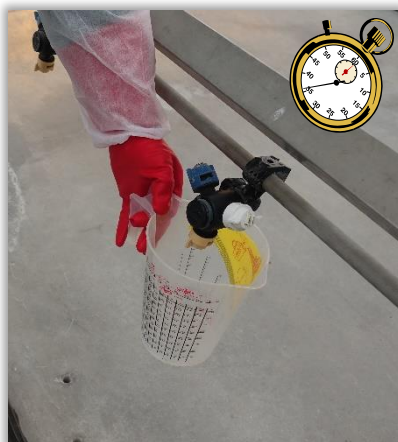
Rys. 83. Pomiar wydatku rozpylacza do pojemnika miarowego.
