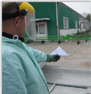
Rys. 76. Ocena jednorodności kąta rozpylania z wykorzystaniem papierowego wzorca.
