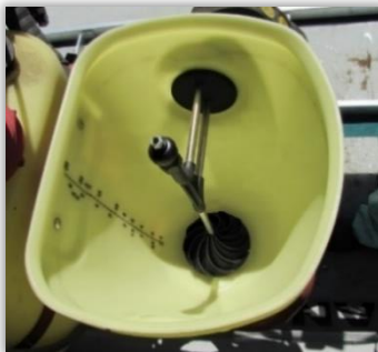
Rys. 49. Rozwadniacz boczny montowany obok zbiornika.
