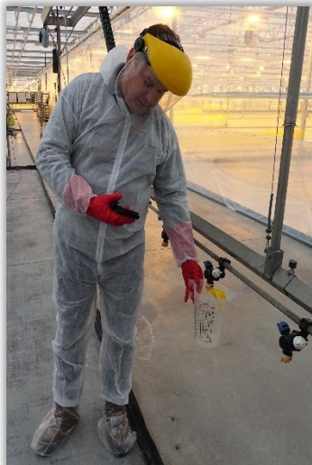
Rys. 80. Pomiar wydatku rozpylacza za pomocą pojemnika miarowego.
