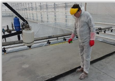
Rys. 69 i 70. Pomiar odległości między rozpylaczami na belce.
