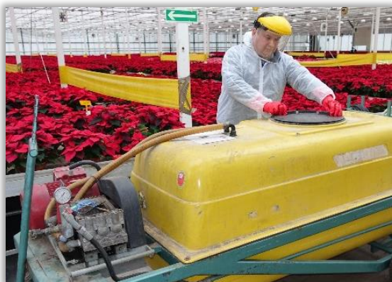
Rys. 17. Pokrywa zbiornika uszczelniana przez obrót.
