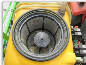
Rys. 22 i 23. Sito z rozwadniaczem preparatów w otworze wlewowym opryskiwacza i bez rozwadniacza (po prawej).
