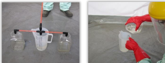
Rys. 77 i 78. Pomiar wydatku rozpylaczy do pojemnika miarowego i do niewyskalowanych pojemników oraz pomiar objętości cieczy zebranej do niewyskalowanych pojemników.
