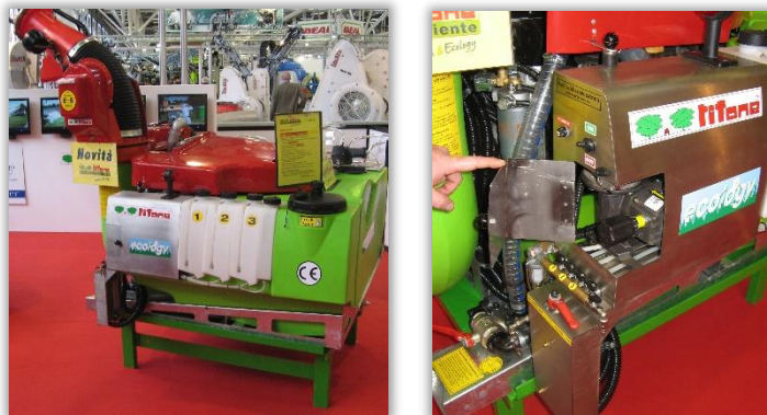
Rys. 37 i 38. Opryskiwacz z systemem iniekcji środka ochrony roślin – możliwe stosowanie trzech preparatów jednocześnie lub zamiennie – wykorzystanie np. w zieleni miejskiej.
