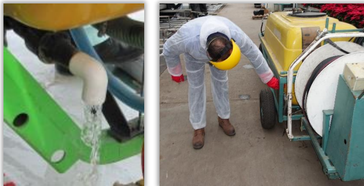
Rys. 28 i 29. Zawór spustowy układu opróżniania opryskiwacza i umiejscowienie zaworu w zbiorniku opryskiwacza.
