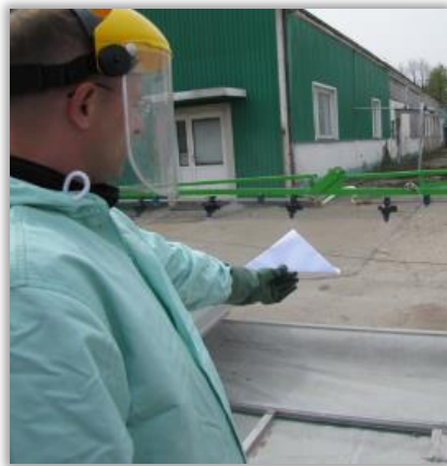
Rys. 66. Ocena jednorodności kąta rozpylania z wykorzystaniem papierowego wzorca.
