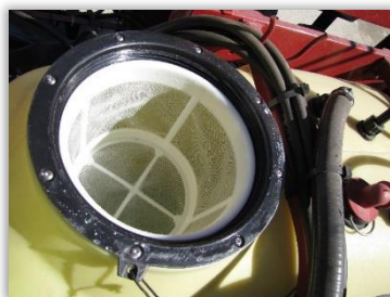
Rys. 22 i 23. Sito z rozwadniaczem preparatów w otworze wlewowym opryskiwacza i bez rozwadniacza (po prawej).
