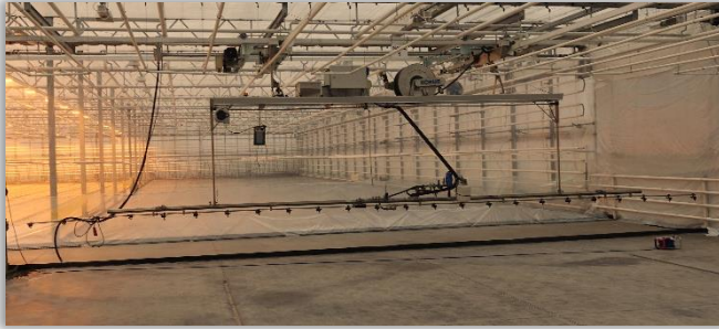
Rys.2. Opryskiwacz szklarniowy – nie zaliczany do grupy „pozostały sprzęt do stosowania środków ochrony roślin w formie oprysku”.
