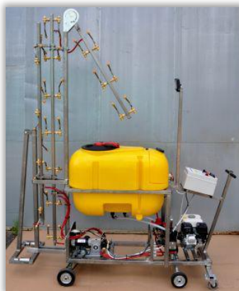
Rys. 7 i 8. Robot opryskowy do szklarni i opryskiwania na zewnątrz – zbiornik 200 l [Źródło: Internet 3, 4].
