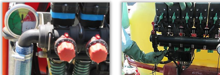
Rys. 45 i 46. Zawory kompensacyjne opryskiwacza sadowniczego i polowego.
