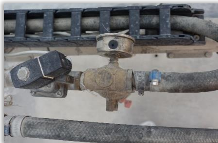
Rys. 47. Elementy układu cieczowego: przewody, opaski.
