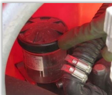
Rys. 33. Zbiornik wskaźnikowy poziomu oleju w pompie przeponowej opryskiwacza.
