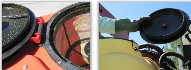
Rys. 19 i 20. Mocowanie pokrywy na zawiasie i za pomocą linki.
