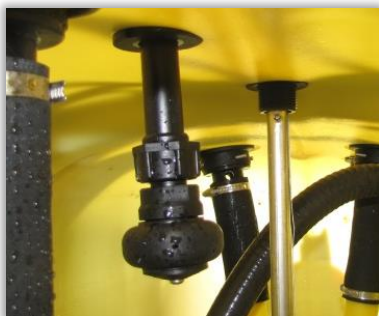
Rys. 54 i 55. Zraszacz do płukania wnętrza zbiornika.
