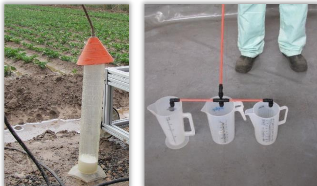
Rys. 75 i 76. Pomiar wydatku rozpylaczy do menzury miarowej lub do wyskalowanych pojemników miarowych.
