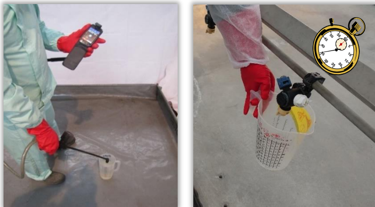
Rys. 73 i 74. Pomiar wydatku rozpylacza do pojemnika miarowego.
