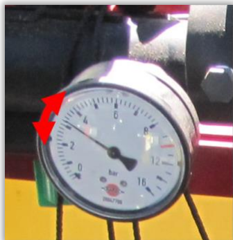
Rys. 43. Manometr z zaznaczonym zakresem drgań wskazówki.
