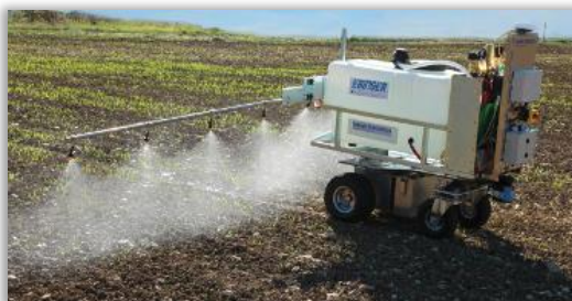
Rys. 6. Robot opryskowy do szklarni i opryskiwania na zewnątrz – zbiornik 200 l [Źródło: Internet 2].
