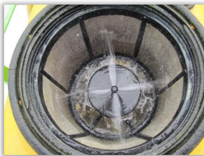
Rys. 50. Rozwadniacz zamontowany w sicie wlewowym zbiornika opryskiwacza.
