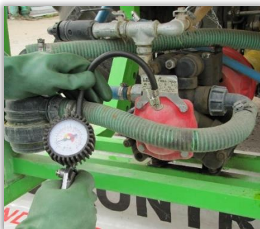
Rys. 30. Sprawdzenie ciśnienia w powietrzniku za pomocą manometru zamontowanego na przewodzie ciśnieniowym pompki lub sprężarki.
