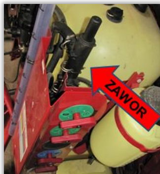
Rys. 35. Zawór bezpieczeństwa montowany w bezpośrednim sąsiedztwie układu zaworów (opryskiwacz polowy).
