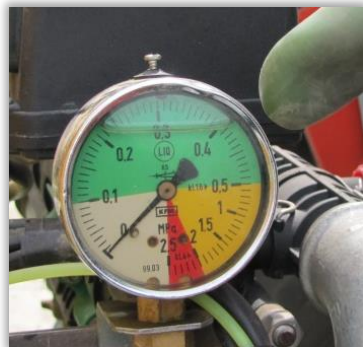
Rys. 44. Manometr glicerynowy - wskazówka jest zanurzona w glicerynie tłumiącej drgania.
