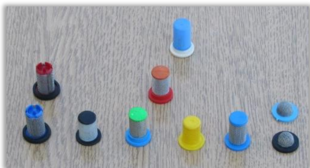
Rys. 62. Różne typy i rozmiary filtrów rozpylaczy. Kolor filtra oznacza gęstość oczek siatki (liczba mesh).
