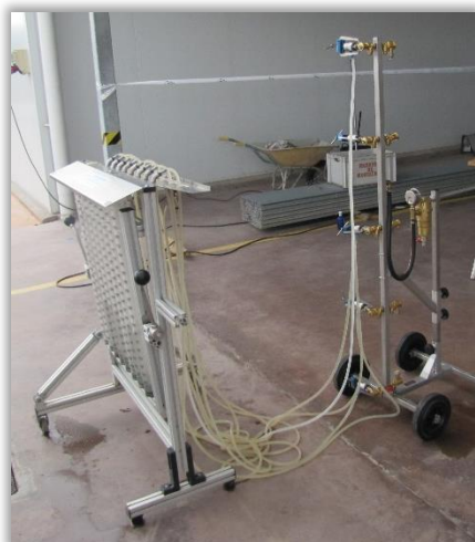
Rys. 5. Pionowa belka opryskowa podczas badania wydatku rozpylaczy.
