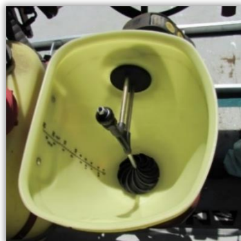
Rys. 51. Rozwadniacz boczny montowany obok zbiornika.
