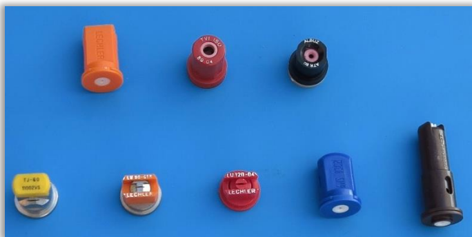
Rys. 63. Sposoby oznaczenia rozpylaczy zawierające ich typ i rozmiar.
