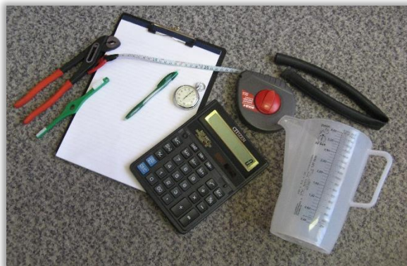
Rys. 65. Zestaw przyborów do kalibracji opryskiwacza: kubek miarowy, stoper, kalkulator, klucz nastawny do odkręcania rozpylacza, miara taśmowa i przybory do pisania.
