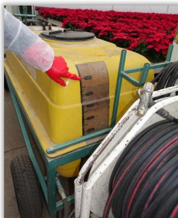
Rys. 27. Wskaźnik poziomu cieczy i bęben z nawiniętym przewodem cieczowym zakończonym pistoletem opryskowym.
