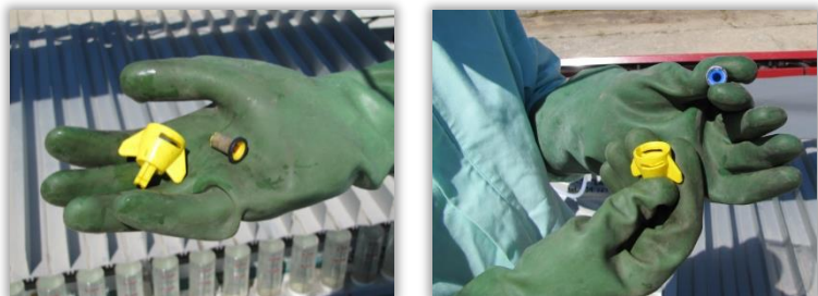
Rys. 60 i 61. Filtr rozpylacza typ 2: rozmiar 1 i rozmiar 2..
