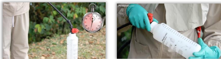
Rys. 70 i 71. Kalibańka założona na rozpylacz lancy opryskowej i wyskalowana kalibańka [Źródło: Internet 7].
