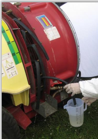
Rys. 64. Dętka rowerowa założona na rozpylacz, umożliwiającą szczelne połączenie rozpylacza z pojemnikiem zbierającym ciecz.
