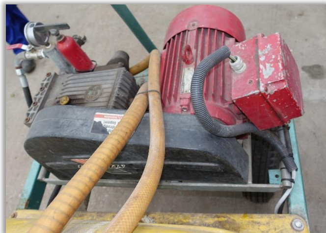
Rys. 13. Osłona napędu pompy - napęd od silnika elektrycznego.
