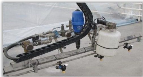
Rys. 36. Dozownik nawozów stosowany w systemach iniekcyjnych i zbiornik na środek ochrony roślin.
