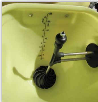
Rys. 53. Płuczka opakowań po środkach ochrony roślin montowana w rozdznaczu bocznym opryskiwacza.
