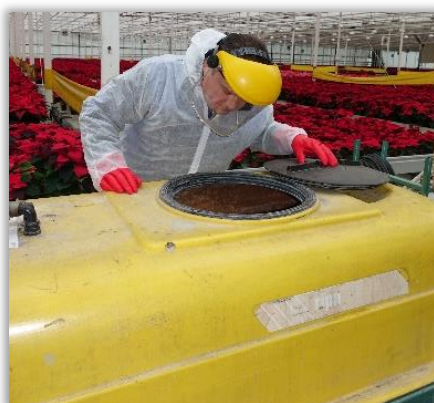
Rys. 25. Obserwacja jakości mieszania wewnątrz zbiornika.
