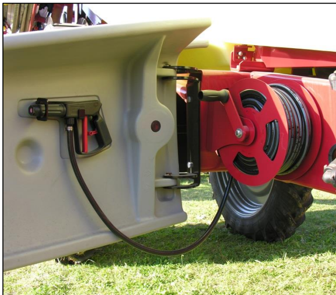
Rys. 21. Pistolet ciśnieniowy i zwijacz węża w zestawie do zewnętrznego mycia opryskiwacza
