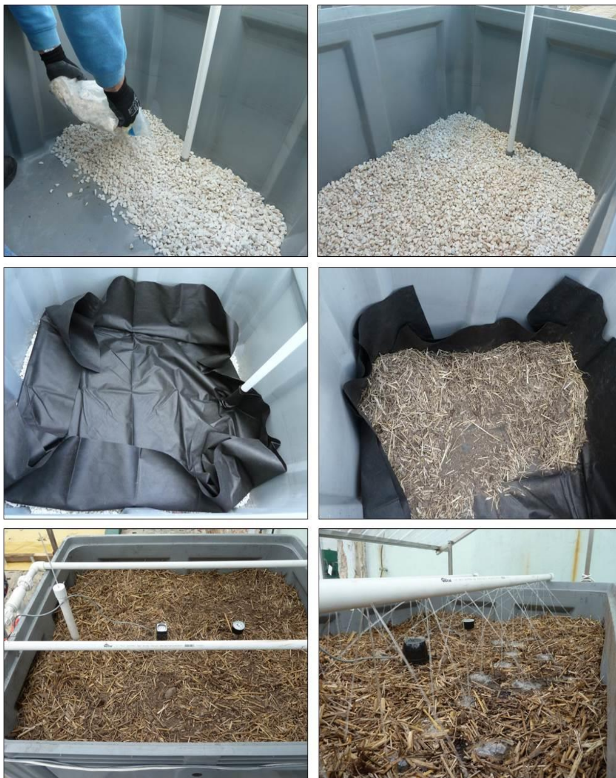
Rys. 48. Kolejne etapy wypełnienia stanowiska VERTIBAC
