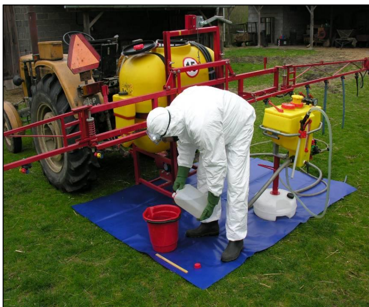
Rys. 14. Zabezpieczenie gleby przed zanieczyszczeniem w miejscu sporządzania ciecży użytkowej
