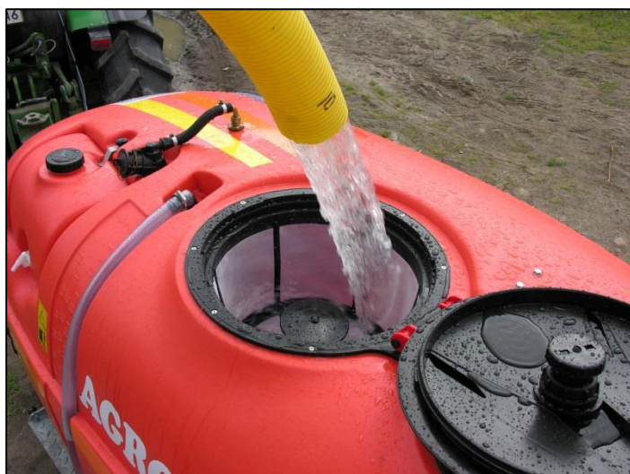
Rys. 15. Podczas uzupełniania wody w zbiorniku opryskiwacza koniec węża zasilającego musi się znajdować nad krawędzią otworu wlewowego
