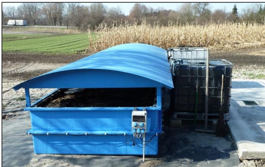
Rys. 41. Stanowisko PHYTOBAC zintegrowane ze stanowiskiem do mycia opryskiwaczy.
