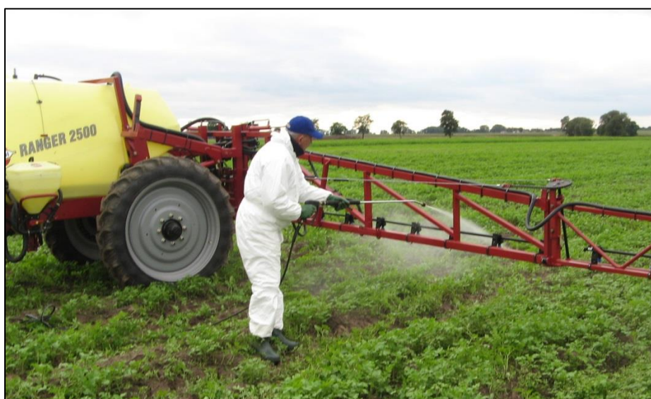
Rys. 20. Mycie opryskiwacza na polu z wykorzystaniem zestawu do mycia zewnętrznego
