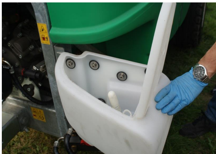
Rys. 9. Zewnętrzny rozwadniacz preparatów na opryskiwaczu sadowniczym
