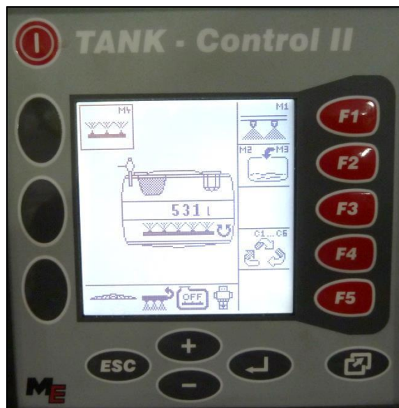
Rys. 19. Panel kontrolny komputerowo sterowanego systemu płukania instalacji cieczowej opryskiwacza
