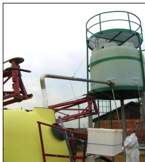
Rys. 16. Napełnianie opryskiwacza ze zbiornika pośredniego
