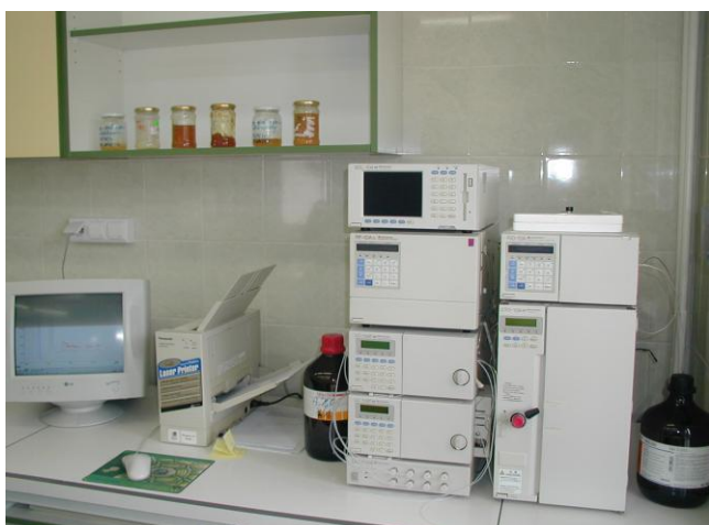
Zestaw HPLC do oznaczania sulfonamidów w miodzie
