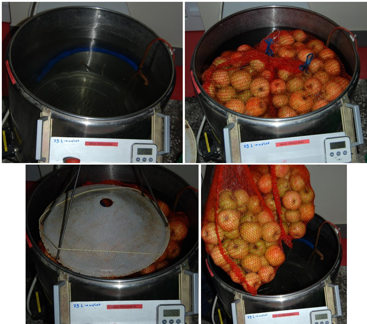
Fot 1. Urządzenie do pozbiorniczego traktowania gorącą wodą i do moczenia owoców oraz przebieg procesu traktowania owoców.
