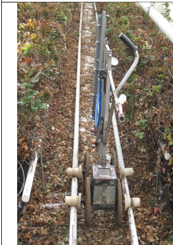
Fot. 48. Wózek z belką do opryskiwania
