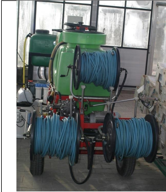
Fot. 46. Opryskiwacz ciśnieniowy posiadający 3 lance do opryskiwania
