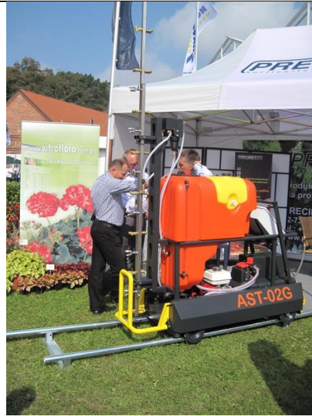
Fot. 47. Opryskiwacz szklarniowy poruszający się po drodze transportowej, zaopatrzony w pionową belkę opryskową
