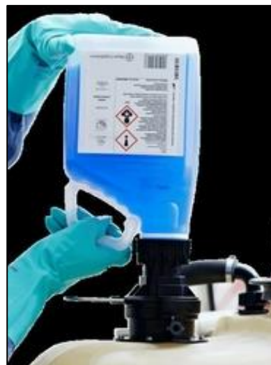
Rys. 13. Zamknięty system wprowadzania preparatów z małych opakowań
