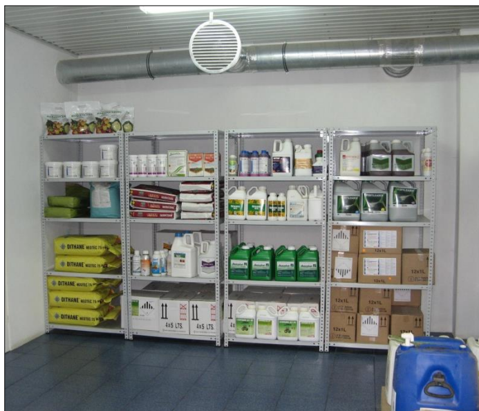
Rys. 3. Organizacja pomieszczenia na środki ochrony roślin zgodnie z dobrą praktyką: wysokosprawna wentylacja, oświetlenie, utwardzona i zmywalna posadzka z glazury, kratka ściekowa z odpływem do zamkniętego zbiornika, regał z elementów metalowych malowanych proszkowo, pojemnik na opróżnione i opłukane opakowania.
