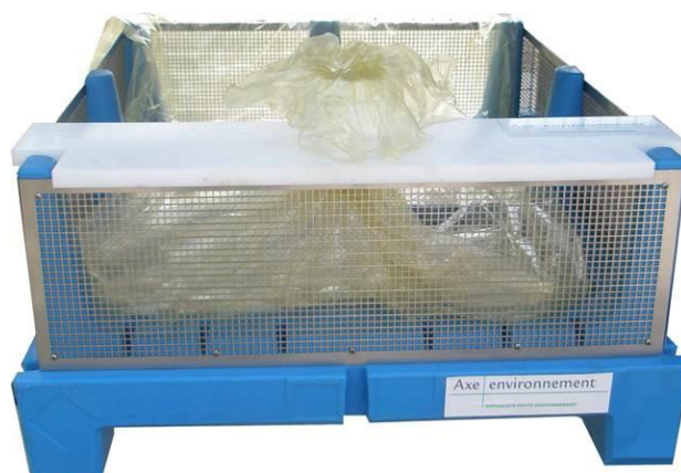
Rys. 53. Polimerowy worek do dehydratacji ciekłych pozostałości na stanowisku OSMOFILM
