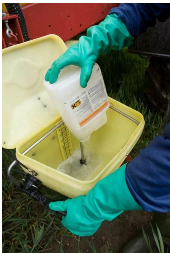
Rys. 34. Płukanie opakowań przy użyciu płuczki w rozwadniaczu preparatów
