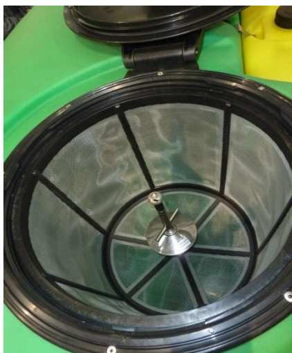
Rys. 8. Rozwadniacz z płuczką opakowań w sicie wlewowym opryskiwacza sadowniczego
