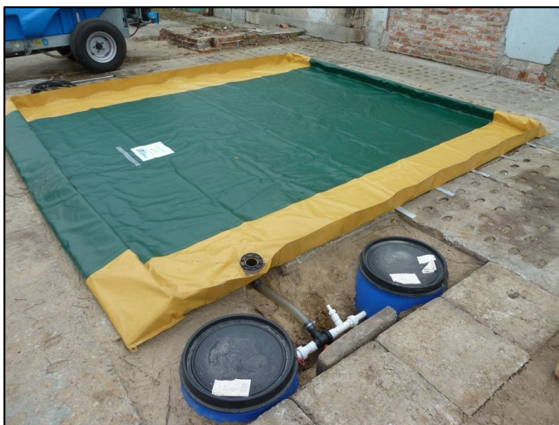
Fot. 1 Stanowisko do mycia opryskiwacza
