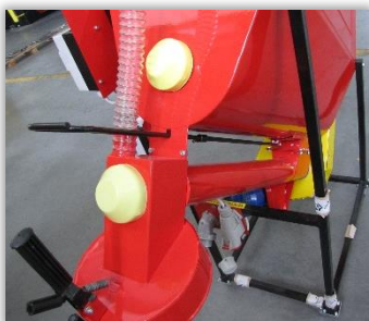
Rys. 127. Dźwignia zasuwy opróżniania komory mieszania.
