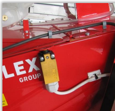
Rys. 61 i 62. Czujnik bezpieczeństwa wyłączający napęd mieszadła przy otwarciu komory mieszania: komora zamknięta (61) i otwarta (62).
