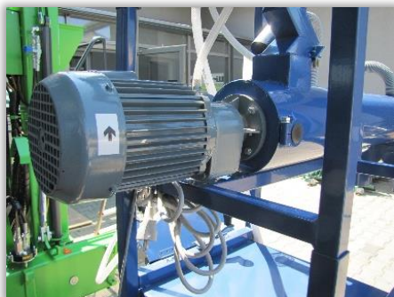
Rys. 12. Silnik napędzający mieszadło zaprawiarki.
