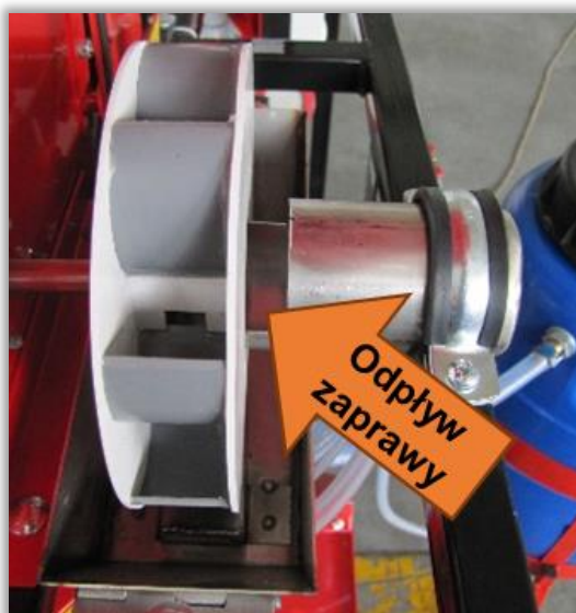
Rys. 114. Koło czepakowe z odpływem cieczy do komory zraszania.
