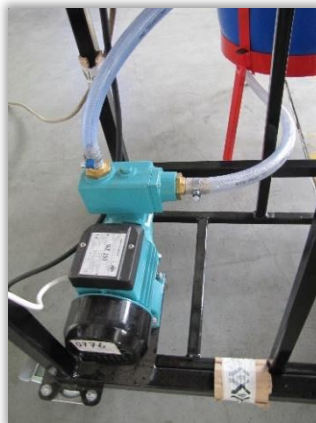
Rys. 70. Pompa zaprawiarki uzyskująca napęd od silnika elektrycznego przez przekładnię kątową.
