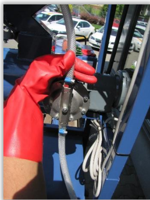
Rys. 68. Przewody cieczowe łączące układ czerpakowy zaprawiarki przepływowej ze zbiornikiem zaprawy.
