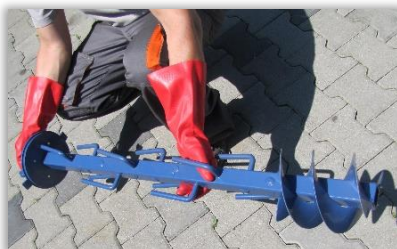
Rys. 119. Przenośnik ślimakowy z palcami mieszadła wyjmowany z układu wylotowego zaprawiarki.
