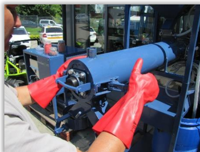
Rys. 96. Komora mieszania zaprawiarki przepływowej - sposób zamknięcia. Rys. 97. Komora mieszania zaprawiarki przepływowej - strefa opróżniania.
