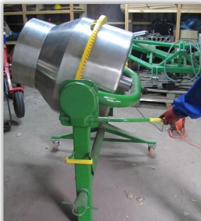
Rys. 125 i 126. Kontrola mechanizmu pochylania bębna w zaprawiarence porcjowej bębnowej.
