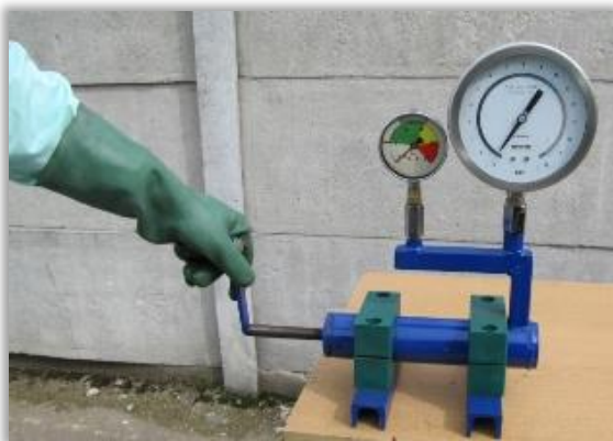
Rys. 63. Stanowisko kontrolne do sprawdzania manometrów opryskiwaczy, które może być wykorzystane do kontroli manometrów zaprawiarek.
