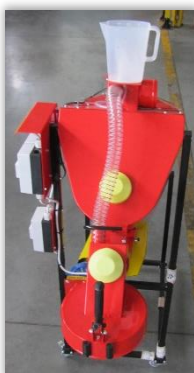
Rys. 13. Zbiornik zaprawy zamocowany na wspólnej ramie z pozostałym wyposażeniem zaprawiarki.
