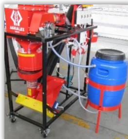
Rys. 13. Zbiornik zaprawy zamocowany na wspólnej ramie z pozostałym wyposażeniem zaprawiarki.
