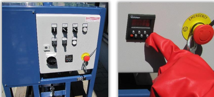
Rys. 64 i 65. Licznik cykli podawania nasion umieszczony na tablicy rozdzielczej zaprawiarki przepływowej.
