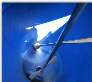
Rys. 79. Filtr ssawny (bliżej) zamocowany do sztywnego przewodu cieczowego oraz czujnik poziomu cieczy przeznaczone do umieszczania na dnie zbiornika zaprawy.
