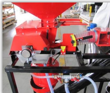
Rys. 16. Układ dawkowania zaprawy - czerpak wahadłowy (srebrny) i komory porcjujące nasiona (niebieskie).
