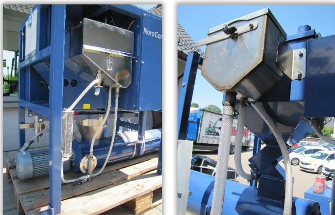
Rys. 66 i 67. Przewody cieczowe układu czepakowego i kalibracyjnego zaprawiarki przepływowej.
