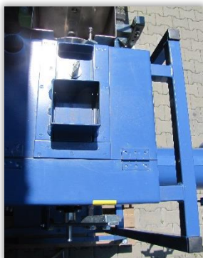
Rys. 35. Zasuwa ograniczająca przepływ nasion w zaprawiarence przepływowej.
