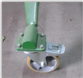
Rys. 34. Koła jezdne z blokadą - zaprawiarka porcjowa bębnowa.
