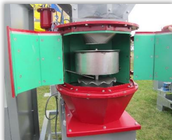
Rys. 72. Komora zraszania zaprawiarki przepływowej z otwartą osłoną.
