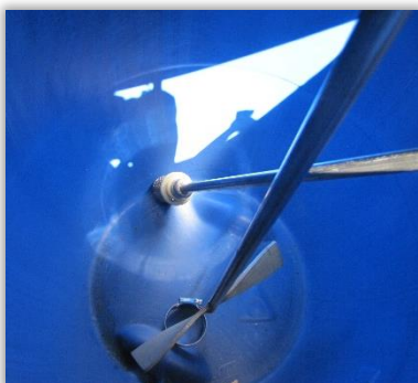
Rys. 57. Czujnik poziomu zaprawy w zbiorniku, umożliwiający zatrzymanie podawania nasion przy braku zaprawy.
