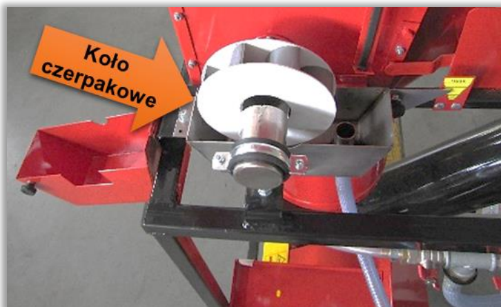
Rys. 113. Kołowy układ czepakowy zaprawiarki z regulacją kąta nachylenia rezerwuaru.
