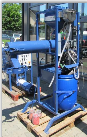
Rys. 8 i 9. Zaprawiarki przepływowe stosowane do stosowania zapraw w formie ciekłej.
