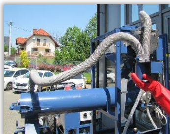
Rys. 82. Przewody łączące zaprawiarkę z urządzeniem odpylającym.
