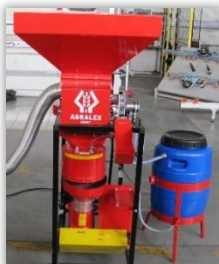
Rys. 43. Zbiornik zaprawy z pokrywą stojący na ramie zaprawiarki.
