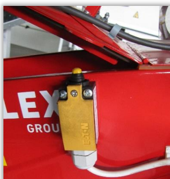
Rys. 61 i 62. Czujnik bezpieczeństwa wyłączający napęd mieszadła przy otwarciu komory mieszania: komora zamknięta (61) i otwarta (62).
