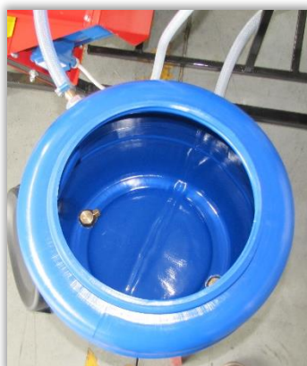
Rys. 129 i 130. Zbiornik zaprawy z przewodem powrotu zaprawy spełniającym rolę mieszadła.
