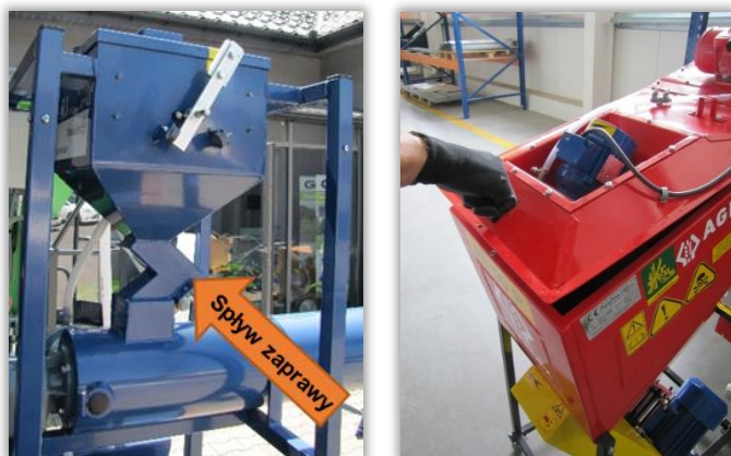
Rys. 100. Komora z grawitacyjnym, swobodnym spływem zaprawy - zaprawa jest „zabierana” przez nasiona opadające grawitacyjnie po specjalnie ukształtowanej powierzchni.
