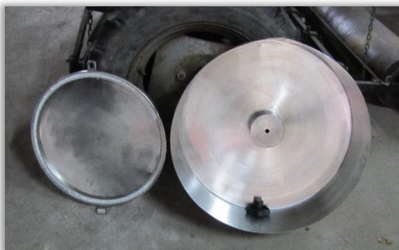
Rys. 48. Pokrywy wewnętrzna (z lewej) i zewnętrzna bębna zaprawiarki porcjowej.
