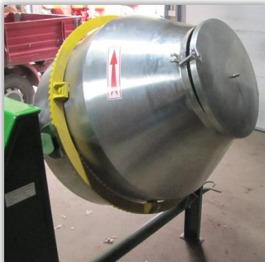
Rys. 92. Zamknięta pokrywą komora (bęben) mieszania zaprawiarki porcjowej z mieszalnikami bębnowym.
