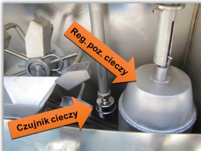
Rys. 111. Regulacja głębokości czerpania za pomocą ustalenia poziomu cieczy w rezerwarze poprzez zmianę wysokości poziomu odpływu.
