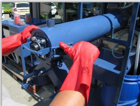
Rys. 133. Mechanizm zamka komory mieszania.
