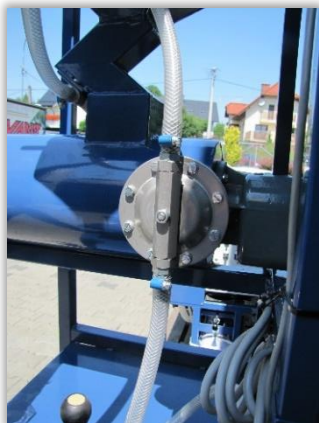
Rys. 70. Pompa zaprawiarki uzyskująca napęd od silnika elektrycznego przez przekładnię kątową.
