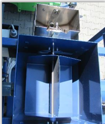
Rys. 115. Układ przekazania ruchu elementu odmierzającego przepływ nasion do elementu poruszającego czerpakami.
