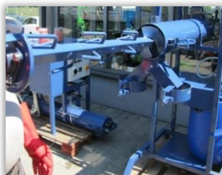
Rys. 119. Przenośnik ślimakowy z palcami mieszadła wyjmowany z układu wylotowego zaprawiarki.
