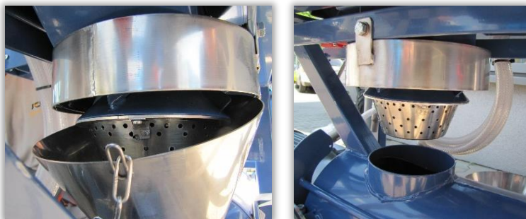
Rys. 98 i 99. Widok wnętrza komory zraszania z rotacyjnym elementem zraszającym.
