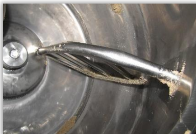
Rys. 135 i 136. Mieszadła o obłym kształcie we wnętrzu bębna zaprawiarki porcjowej.
