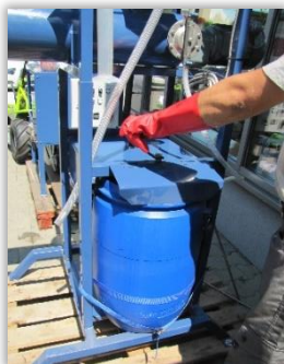
Rys. 26. Zbiornik na roztwór zaprawiający ustawiony na ramie zaprawiarki.
