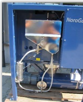
Rys. 51. Zawory przełączające zaprawiarkę w tryb pracy lub kalibracji oraz układ czerpakowy zaprawiarki przepływowej.
