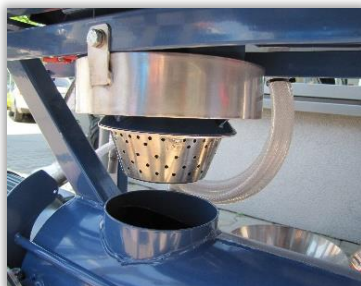
Rys. 72. Komora zraszania zaprawiarki przepływowej z otwartą osłoną.
