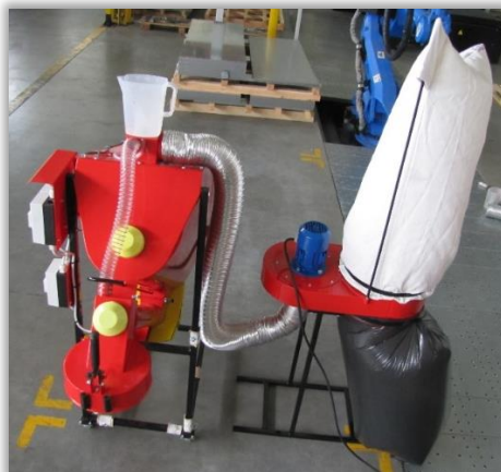
Rys. 81. Zaprawiarka porcjowa i współpracujący z nią system odpylania.
