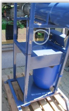
Rys. 13. Zbiornik zaprawy zamocowany na wspólnej ramie z pozostałym wyposażeniem zaprawiarki.
