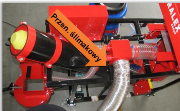
Rys. 117. Komora mieszania ze znajdującym się w jej wnętrzu (tu niewidocznym) przenośnikiem ślimakowym zaprawiarki przepływowej.
