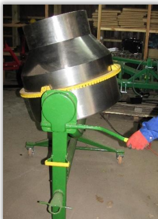
Rys. 125 i 126. Kontrola mechanizmu pochylania bębna w zaprawiarence porcjowej bębnowej.
