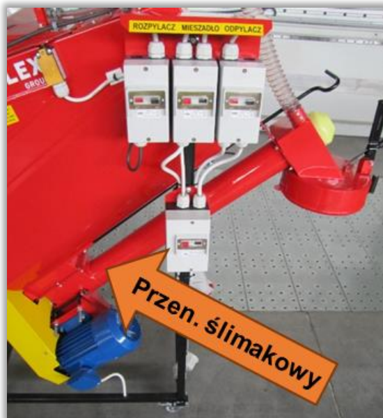
Rys. 118. Przenośnik ślimakowy zaprawiarki porcjowej (tu niewidoczny) biorący udział w opróżnianiu komory mieszania.
