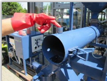
Rys. 84. Otwór przyłącza urządzenia odpylającego do komory mieszania w miejscu urządzenia opróżniającego.
