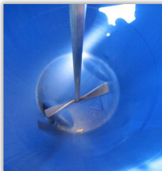
Rys. 131. Zbiornik zaprawy z mieszadłem mechanicznym - widoczna korba mieszadła.
