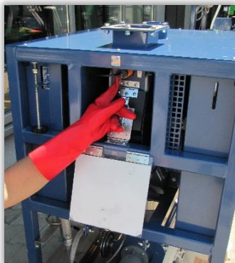
Rys. 55. Miejsce zamontowania bezpiecznika wyłączającego przepływ zaprawy.
