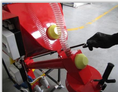
Rys. 127. Dźwignia zasuwy opróżniania komory mieszania.
