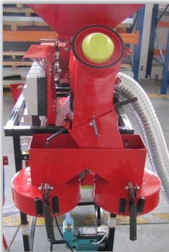
Rys. 123 i 124. Układ wylotowy zaprawiarki z workownicą dwudrożną – zwrotnica przepływu nasion skierowana w lewo (123) lub w prawo (124).
