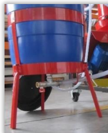
Rys. 43. Zbiornik zaprawy z pokrywą stojący na ramie zaprawiarki.
