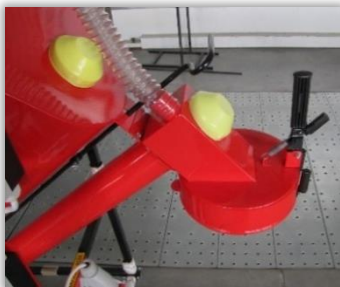
Rys. 121. Układ wylotowy zaprawiarki z workownicą dwudrożną.
