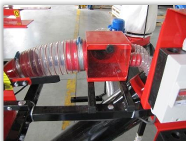
Rys. 88. Wziernik kontrolny przebiegu procesu zaprawiania nasion.
