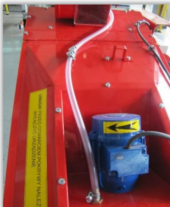
Rys. 30. Silnik elektryczny napędzający bęben zaprawiarki porcjowej (bębnowej).
