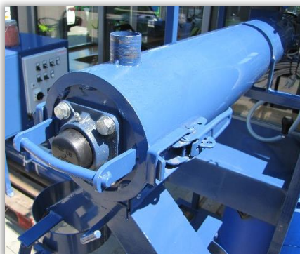
Rys. 35. Zasuwa ograniczająca przepływ nasion w zaprawiarence przepływowej.
