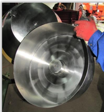
Rys. 92. Zamknięta pokrywą komora (bęben) mieszania zaprawiarki porcjowej z mieszalnikami bębnowym.
