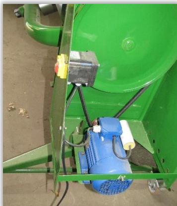
Rys. 30. Silnik elektryczny napędzający bęben zaprawiarki porcjowej (bębnowej).
