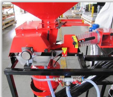
Rys. 51. Zawory przełączające zaprawiarkę w tryb pracy lub kalibracji oraz układ czerpakowy zaprawiarki przepływowej.
