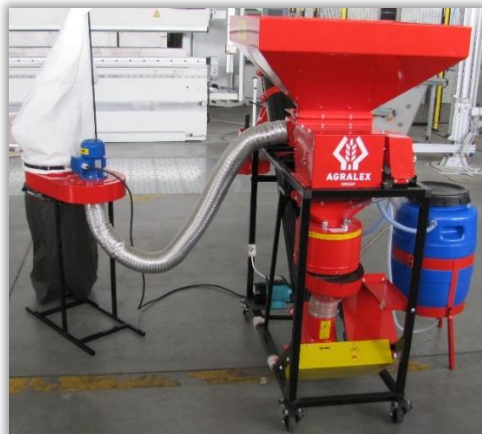
Rys. 39. Urządzenie odpylające współpracujące z zaprawiarką.
