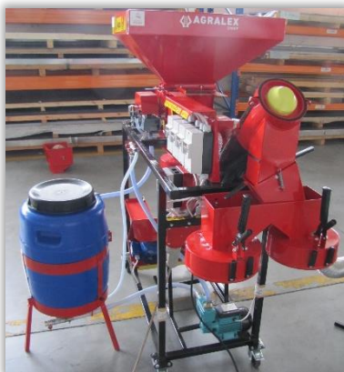
Rys. 129 i 130. Zbiornik zaprawy z przewodem powrotu zaprawy spełniającym rolę mieszadła.
