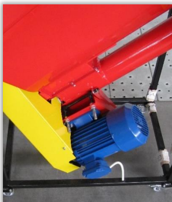
Rys. 32. Silnik napędzający układ mieszania zaprawiarki porcjowej.
