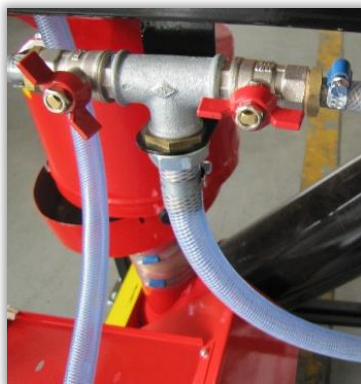
Rys. 28 i 29. Zawory ograniczające dopływ roztworu zaprawiającego do zbiornika, z którego zaprawa jest czerpana (rezewuaru zaprawy).
