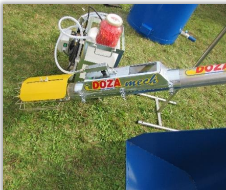
Rys. 105 i 106. Zaprawiarka montowana na przenośniku ślimakowym do zboża. Podawanie zaprawy i zraszanie ciśnieniowe.
