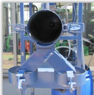
Rys. 96. Komora mieszania zaprawiarki przepływowej - sposób zamknięcia. Rys. 97. Komora mieszania zaprawiarki przepływowej - strefa opróżniania.
