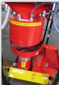
Rys. 74. Komora zraszania zaprawiarki przepływowej z częściowo zdemontowaną dolną osłoną.
