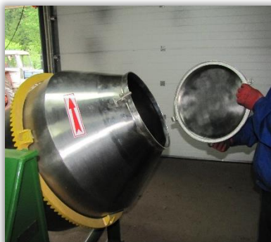
Rys. 46. Pokrywa zewnętrzna bębna zaprawiarki porcjowej.
