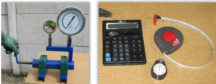
Rys. 140 i 141. Obowiązkowe wyposażenie stacji kontroli - praska i manometr kontrolny (140) oraz przymiar wstępowy, stoper i kalkulator (141).
