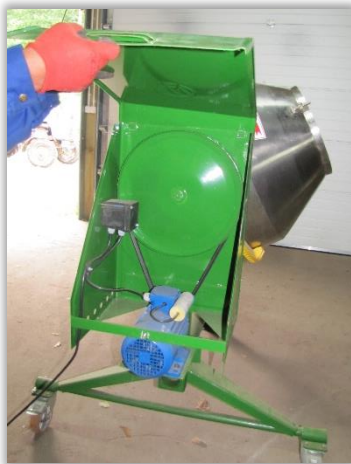
Rys. 10. Pasek napędowy zaprawiarki bębnowej.
