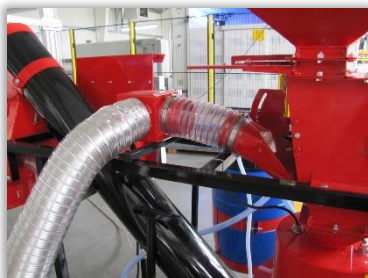
Rys. 86. Przewód pneumatyczny przyłącza urządzenia odpylającego do komory odmierzania nasion.
