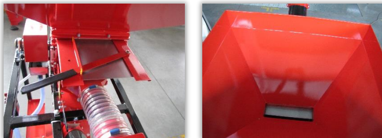
Rys. 22. Dźwignia przesłony układu zasypowego nasion.
