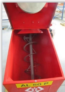
Rys. 74. Komora zraszania zaprawiarki przepływowej z częściowo zdemontowaną dolną osłoną.
