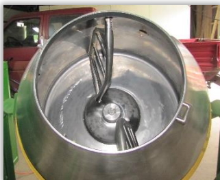
Rys. 135 i 136. Mieszadła o obłym kształcie we wnętrzu bębna zaprawiarki porcjowej.
