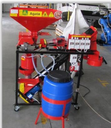
Rys. 68. Przewody cieczowe łączące układ czerpakowy zaprawiarki przepływowej ze zbiornikiem zaprawy.
