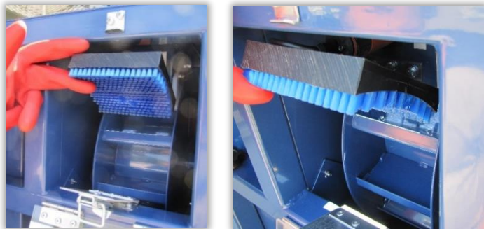
Rys. 20 i 21. Szczotki wyrównujące napętnienie komór porcjujących nasiona.
