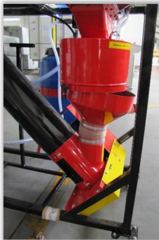
Rys. 94. Komora mieszania zaprawiarki porcjowej z mieszalnikiem ślimakowym. Rys. 95. Komora zraszania zaprawiarki przepływowej.
