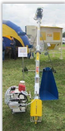
Rys. 105 i 106. Zaprawiarka montowana na przenośniku ślimakowym do zboża. Podawanie zaprawy i zraszanie ciśnieniowe.
