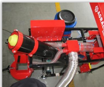
Rys. 86. Przewód pneumatyczny przyłącza urządzenia odpylającego do komory odmierzania nasion.
