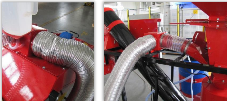
Rys. 90 i 91. Sposób połączenia przewodu urządzenia odpylającego z elementem zaprawiarki porcjowej (90) i przepływowej (91).
