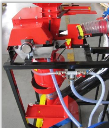
Rys. 28 i 29. Zawory ograniczające dopływ roztworu zaprawiającego do zbiornika, z którego zaprawa jest czerpana (rezewuaru zaprawy).
