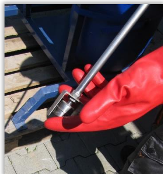
Rys. 57. Czujnik poziomu zaprawy w zbiorniku, umożliwiający zatrzymanie podawania nasion przy braku zaprawy.
