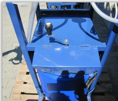
Rys. 131. Zbiornik zaprawy z mieszadłem mechanicznym - widoczna korba mieszadła.
