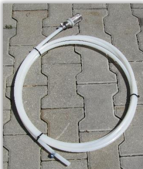
Rys. 77. Filtr ssawny z elastycznym przewodem cieczowym.
