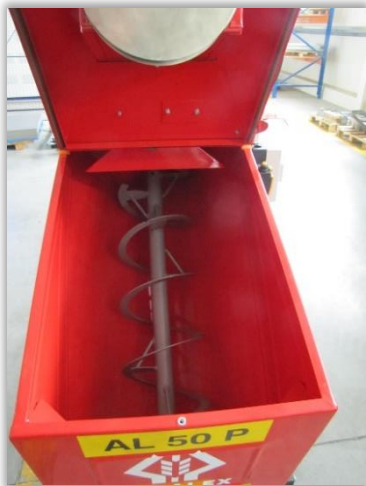
Rys. 94. Komora mieszania zaprawiarki porcjowej z mieszalnikiem ślimakowym. Rys. 95. Komora zraszania zaprawiarki przepływowej.
