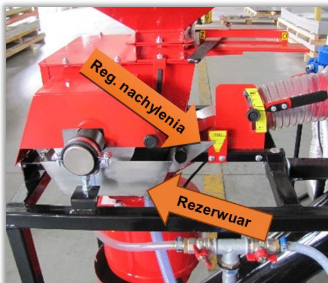
Rys. 112. Regulacja głębokości czerpania poprzez zmianę kąta nachylenia całego rezerwuaru.
