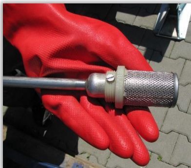
Rys. 77. Filtr ssawny z elastycznym przewodem cieczowym.
