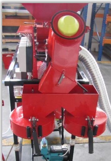
Rys. 123 i 124. Układ wylotowy zaprawiarki z workownicą dwudrożną – zwrotnica przepływu nasion skierowana w lewo (123) lub w prawo (124).
