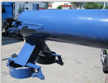
Rys. 121. Układ wylotowy zaprawiarki z workownicą dwudrożną.
