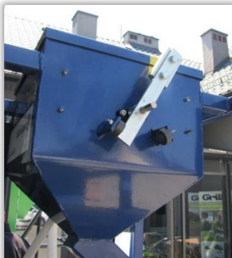
Rys. 53. Wskaźnik ruchów wahadłowego układu odmierzania ilości przepływających nasion.
