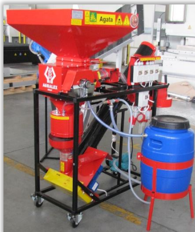
Rys. 8 i 9. Zaprawiarki przepływowe stosowane do stosowania zapraw w formie ciekłej.
