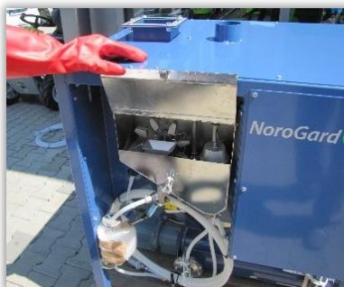
Rys. 109. Obudowa układu dwuczerpakowego z przewodami cieczowymi odprowadzającymi zaprawę do komory zraszania i do zbiornika (przelew).
