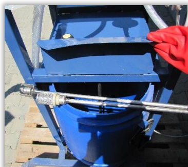
Rys. 79. Filtr ssawny (bliżej) zamocowany do sztywnego przewodu cieczowego oraz czujnik poziomu cieczy przeznaczone do umieszczania na dnie zbiornika zaprawy.
