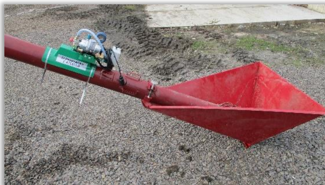
Rys. 102. Zaprawiarka montowana na przenośniku ślimakowym do zboża. Podawanie zaprawy i zraszanie ciśnieniowe.
