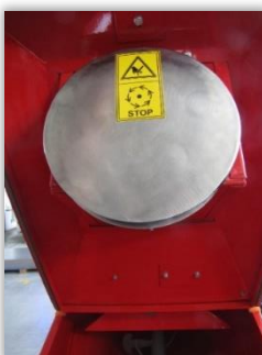
Rys. 74. Komora zraszania zaprawiarki przepływowej z częściowo zdemontowaną dolną osłoną.
