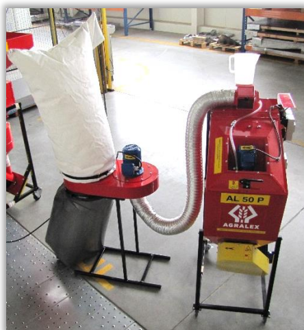
Rys. 4. Zaprawiarka porcjowa i dedykowany system odpylania.
