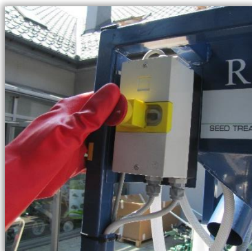
Rys. 59. Wyłącznik bezpieczeństwa układu elektrycznego.
