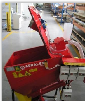
Rys. 37. Zamykana komora mieszania zaprawiarki porcjowej.
