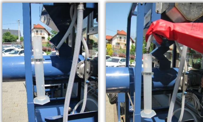
Rys. 49 i 50. Menzura kalibracyjna zaprawiarki przepływowej z czerpakowym układem dozowania – kalibracja na wodzie.
