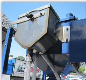
Rys. 109. Obudowa układu dwuczerpakowego z przewodami cieczowymi odprowadzającymi zaprawę do komory zraszania i do zbiornika (przelew).
