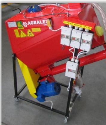
Rys. 32. Silnik napędzający układ mieszania zaprawiarki porcjowej.
