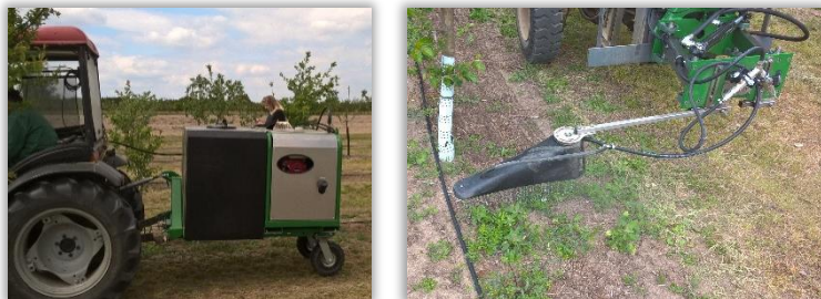
Rys. 2 i 3. Urządzenie do stosowania gorącej wody do zwalczania chwastów (agregat i element roboczy) (Fot. J. Rabcewicz)
