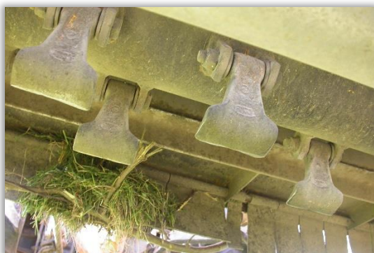
Rys. 8. Bijaki kosiarki bijakowej są obracające się z dużą prędkością w płaszczyźnie pionowej, umieszczone wahliwie na poziomym wale (Fot. J. Rabcewicz)
