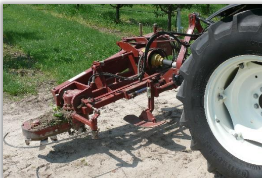
Rys. 12. Urządzenie z automatycznie wycofywanymi zespołami roboczymi (Fot. J. Rabcewicz)
