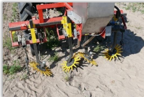
Rys. 1. Czynno-bierne elementy robocze pielnika - gwiazdy (koła palcowe) z odpowiednio wyprofilowanymi zębami (Fot. J. Rabcewicz)
