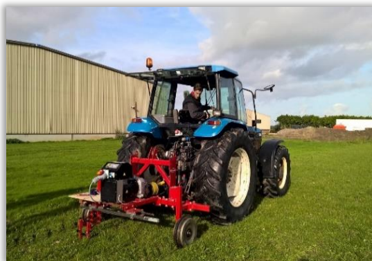
Rys. 17. Prototyp urządzenia do zwalczania chwastów za pomocą prądu elektrycznego o wysokim napięciu (Fot. cordis.europa.eu/docs/results/h2020/733/733687_PS/inter-row-weeder-prototype.jpg )
