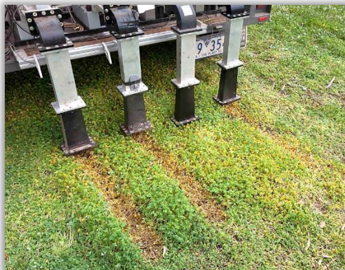
Rys. 6. Prototypowe urządzenie do zwalczania chwastów za pomocą promieniowania mikrofalowego www.goodfruit.com/microwaving-the-weeds-away/
