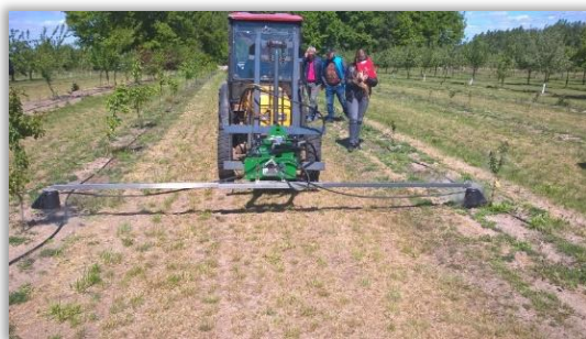
Rys. 16. Urządzenie do zwalczania chwastów za pomocą pary wodnej – działanie dwurzędowe (Fot. J. Rabcewicz)
