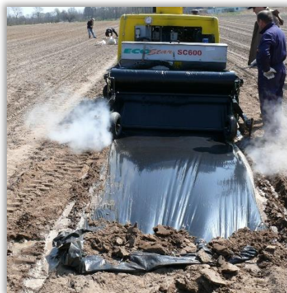
Rys. 9. Rozkładanie folii zabezpieczającej przed wzrostem chwastów jednocześnie z parowaniem podłoża (Fot. J. Rabcewicz)
