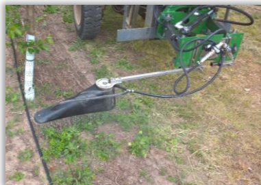
Rys. 2 i 3. Urządzenie do stosowania pary wodnej do zwalczania chwastów (agregat i element roboczy) (Fot. J. Rabcewicz).
