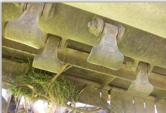
Rys. 8. Bijkas kosiarki bijakowej są obracające się z dużą prędkością w płaszczyźnie pionowej, umieszczone wahliwie na poziomym wale (Fot. J. Rabcewicz).
