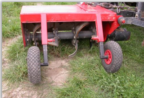
Rys. 10. Noże glebogryzarki sadowniczej w kształcie litery „L” (Fot. J. Rabcewicz).
