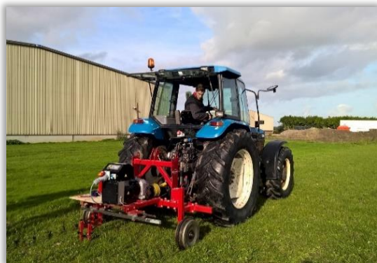
Rys. 17. Prototyp urządzenia do zwalczania chwastów za pomocą prądu elektrycznego o wysokim napięciu (Fot. https://cordis.europa.eu/docs/results/h2020/733/733687_PS/inter-row-weeder-prototype.jpg )
