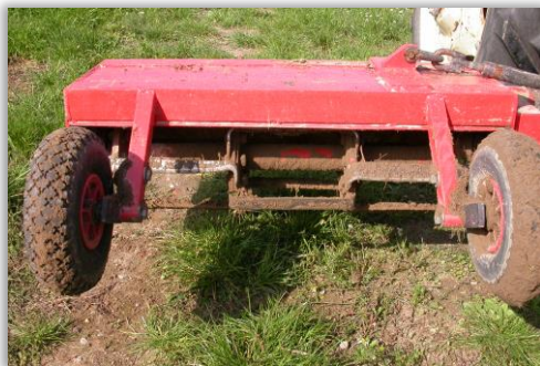
Rys. 11. Noże glebogryzarki sadowniczej w kształcie litery „U” (Fot. J. Rabcewicz).
