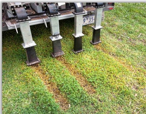
Rys. 6. Prototypowe urządzenie do zwalczania chwastów za pomocą promieniowania mikrofalowego https://www.goodfruit.com/microwaving-the-weeds-away/
