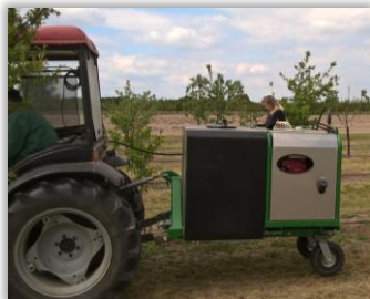
Rys. 2 i 3. Urządzenie do stosowania pary wodnej do zwalczania chwastów (agregat i element roboczy) (Fot. J. Rabcewicz).
