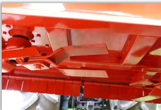
Rys. 7. Noże kosiarki obracające się w płaszczyźnie poziomej (Fot. J. Rabcewicz)
