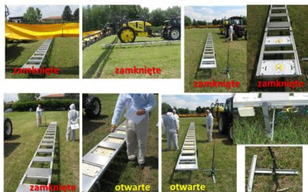
Rys. 25. Etapy pomiaru potencjału znoszenia z wykorzystaniem specjalnego urządzenia – zgodnie z normą ISO 22401.
