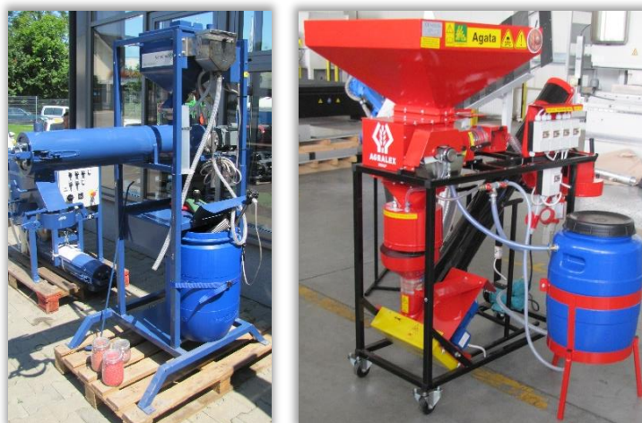
Rys. 12, 13. Zaprawiarki przepływowe stosowane do zaprawiania zaprawą w formie płynnej.
