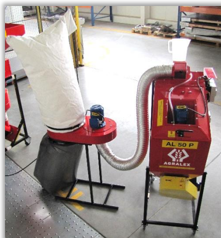
Rys. 7. Zaprawiarka porcjowa i dedykowany system odpylania.
