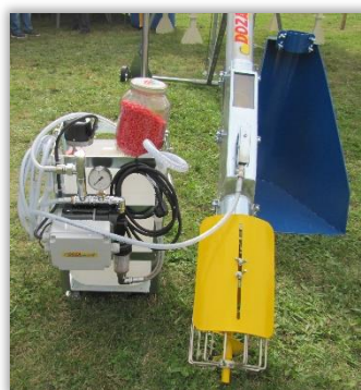
Rys. 8, 9. Zaprawiarka montowana na przenośniku ślimakowym do zboża.
