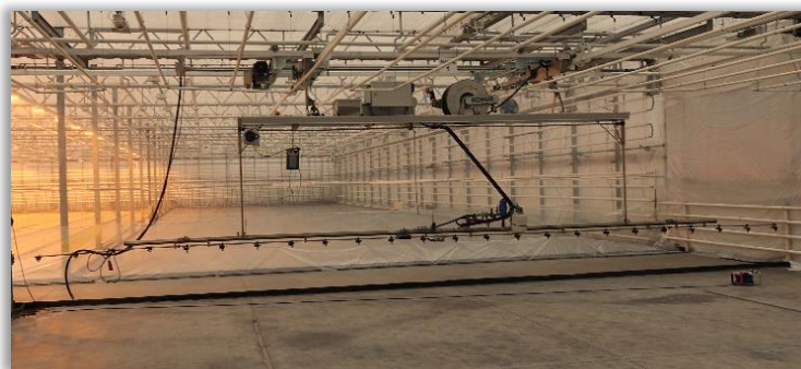
Rys.2. Opryskiwacz szklarniowy częściowo mobilny (ruchoma sekcja opryskująca).
