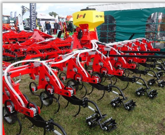
Rys. 14. Rzędowy aplikator granulatu z widocznymi (jasnymi) przewodami doprowadzającymi granulaty.
