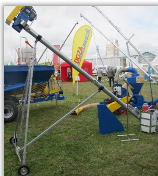
Rys. 8, 9. Zaprawiarka montowana na przenośniku ślimakowym do zboża.
