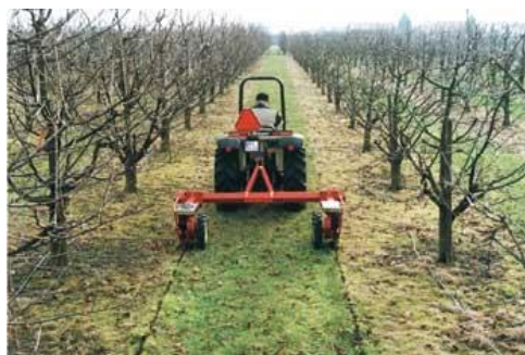
Fot. 1. Dozownik truciźn na gryzonie. Fot 2. Dozownik przy pracy (widoczne ustawienie sekcji na granicy ugory i murawy) ( Ciagnikowy dozownik do środków gryzoniobójczych - Ogroinfo.pl )
