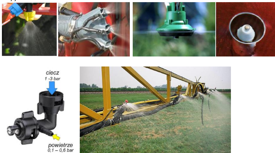
Rys. 16-21. Od lewej: rozpylanie ciśnieniowe, pneumatyczne, rotacyjne (2 typy), dwusystemowe i rozpylacze uderzeniowe.
