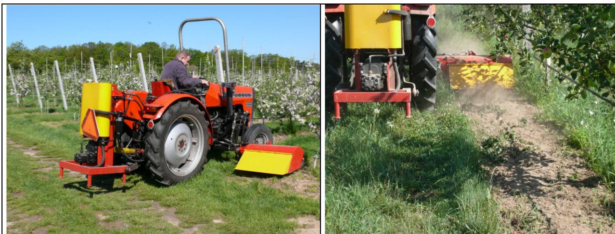
Fot. 1. Glebogryzarka sadownicza zawieszana między osiami kół ciągnika
