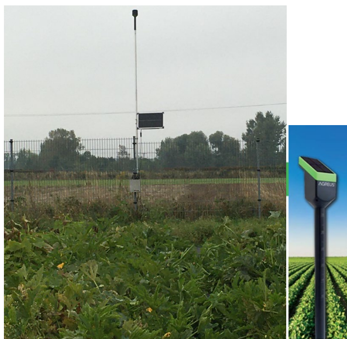
Fot. 4. Stacja bazowa na polu ekologicznym wraz z panelem solarnym do zasilania, z prawej sonda AM 100 https://www.agreus.pl/wp-content/uploads/2020/10/Sonda-glebowa-AM-100.pdf
