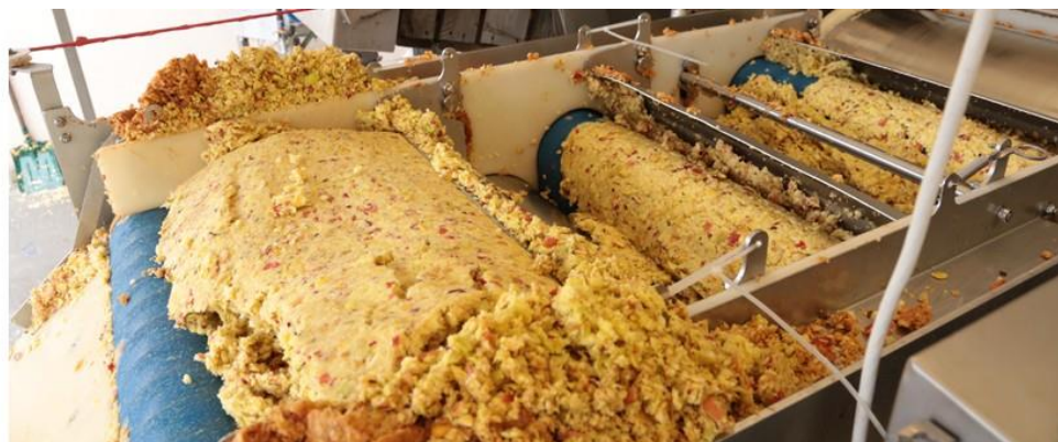
Rys. 2 Wytloki jabłkowe powstające na prasie taśmowej podczas produkcji soku jabłkowego https://www.sadownictwo.com.pl/zupelnie-nowy-biznes-produkcja-pektyn-z-wytlokow-jablek
