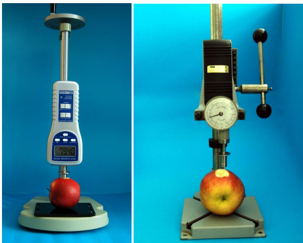
Fot. 11. Zamocowanie ręcznych jędrnościomierzy na statywach (fot. K.P. Rutkowski)
