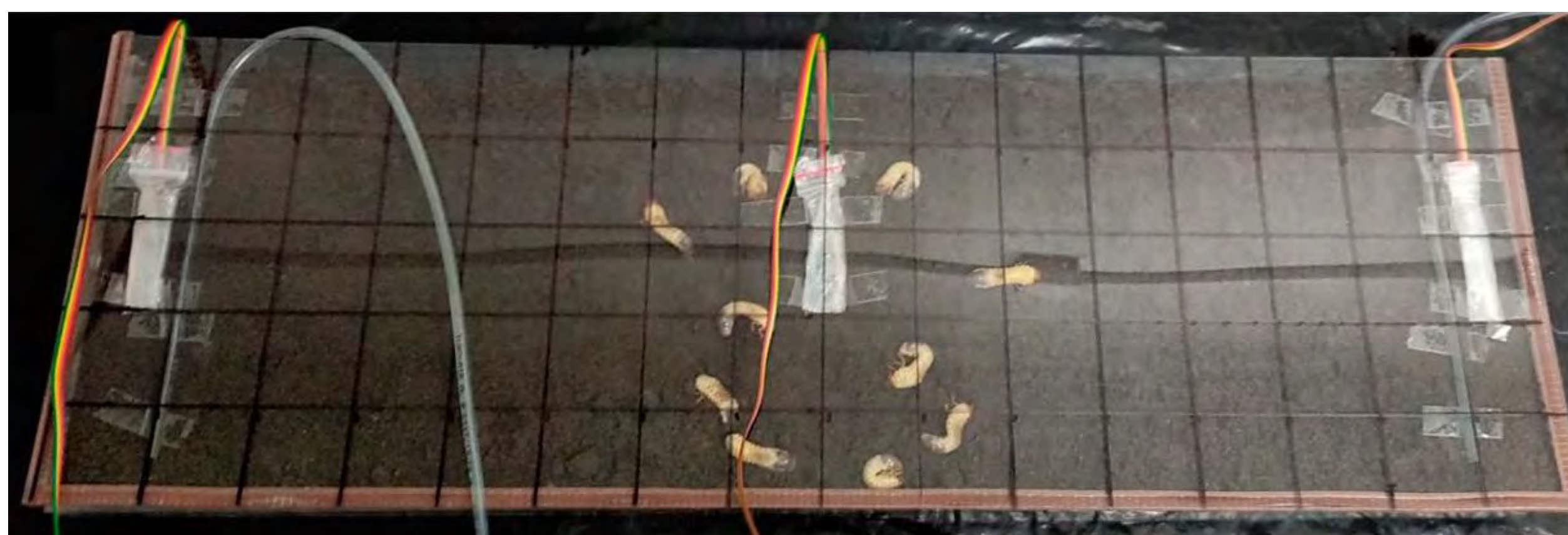
FIG 2. Komora do testowania behawioru pokarmowego larw M. melolontha . Na zdjęciu komora wypełniona glebą, dodatkowo wyposażona w czujniki stężenia CO 2 .
