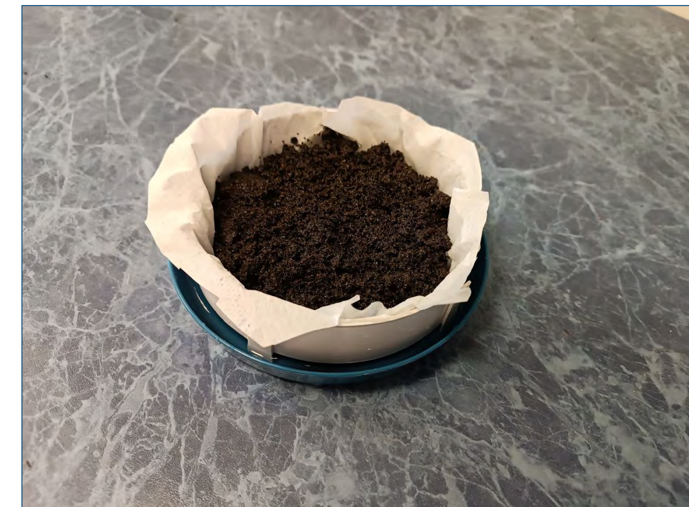
RYS. 4. Ekstrakcja nicieni z wykorzystaniem zmodyfikowanej metody Baermanna na sitach.
