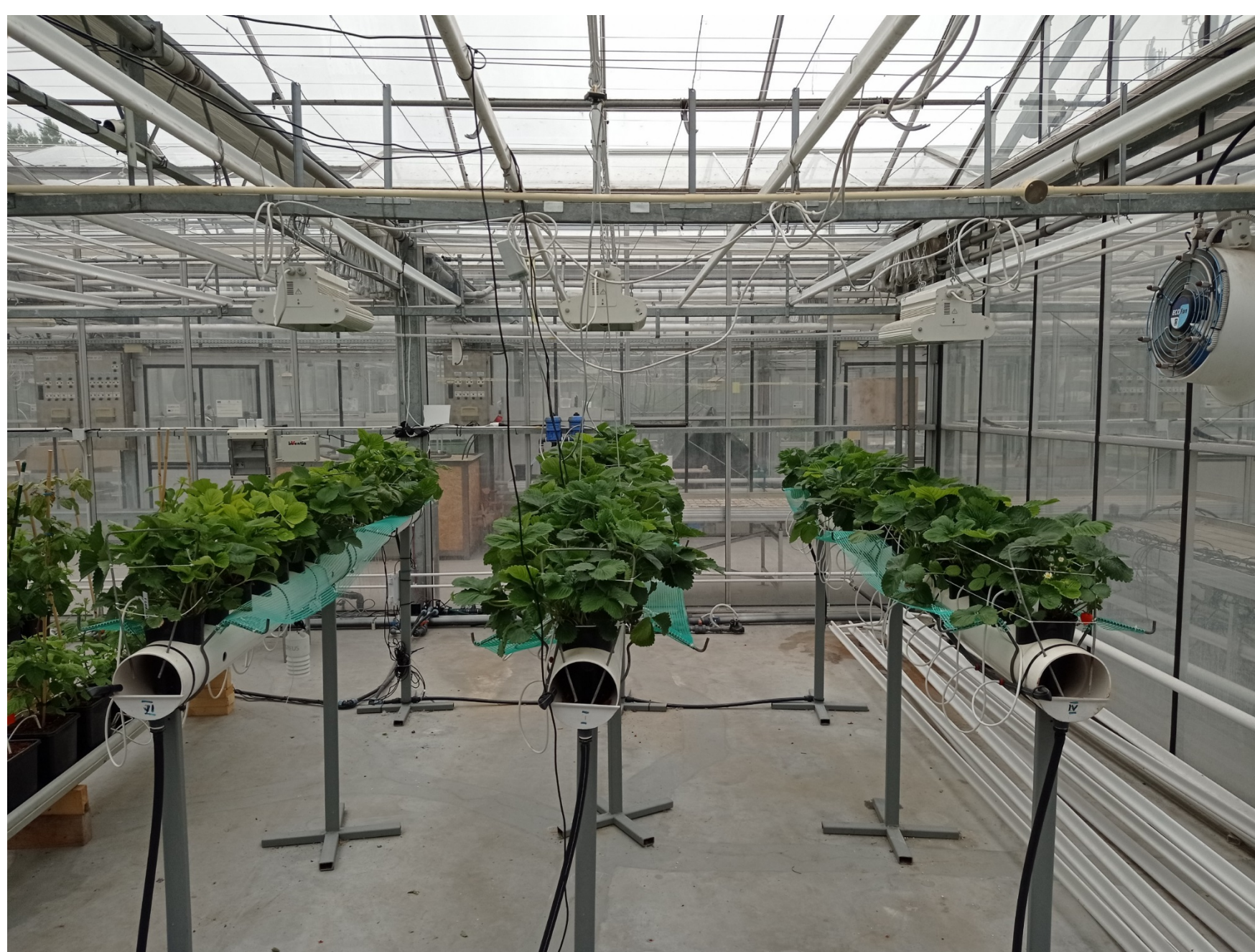
Rośliny uprawiane w rynnie, która jest podwieszona do czujników tensometrycznych
