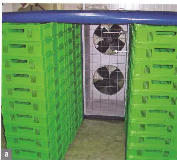
Fot. 3. System tunelowy do schładzania czereśni z wymuszonym przepływem powietrza (a) i zespół wentylatorów o znacznej wydajności (b)
