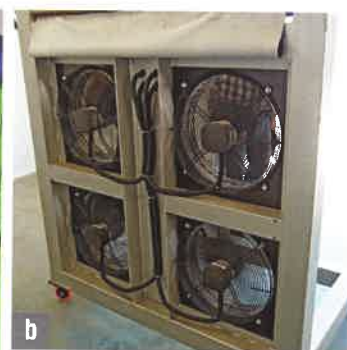
Fot. 3. System tunelowy do schładzania czereśni z wymuszonym przepływem powietrza (a) i zespół wentylatorów o znacznej wydajności (b)
