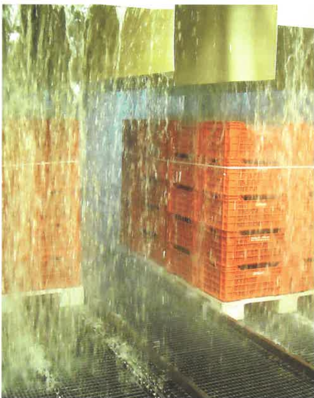
Fot. 5. Czereśnie schładzane pod kurtyną wodną
