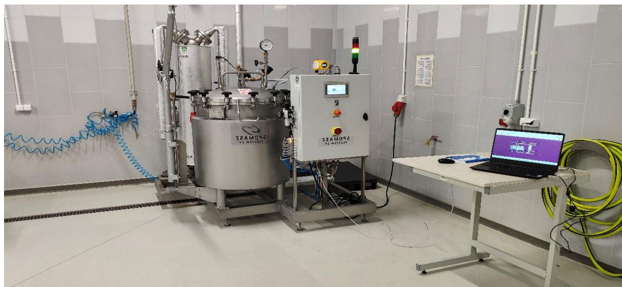
Fot. 1. Autoklaw z automatyzowaną kontrolą procesu sterylizacji.
